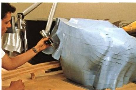
Fig. 4-32: Digitalisation de la maquette de l'EMP – F.O.Gehry – Seattle – USA – 1995 / 2000
