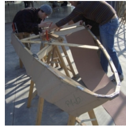
Fig. 4-5: Agrafage d'une laize de carton
