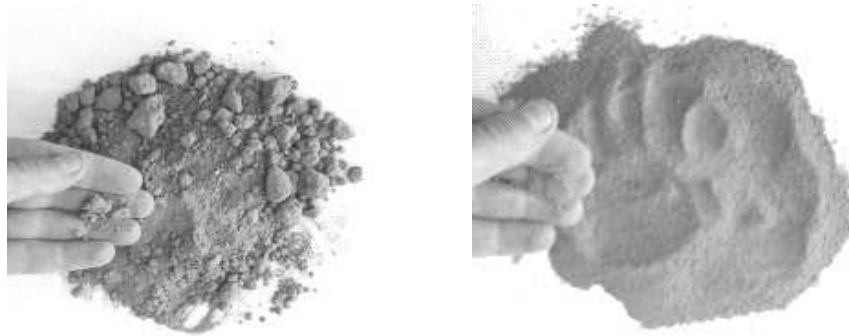
FIG. 3.1 – Photographies du sable limoneux argileux avant et après tamisage à 2 mm.
