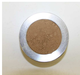
FIG. 3.5 – Echantillon de sol dans son porte-échantillon.
