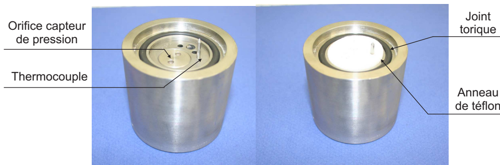
FIG. 3.6 – Capteur autonome de mesure de pression et de température.
