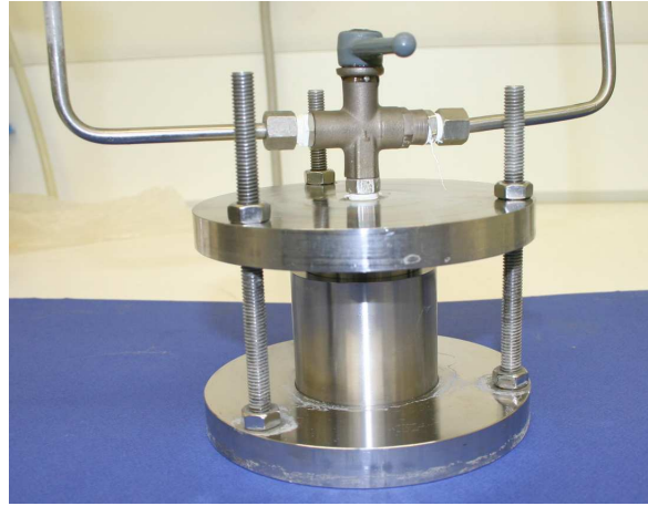
FIG. 3.4 – Cellule de déséquilibre thermodynamique.
