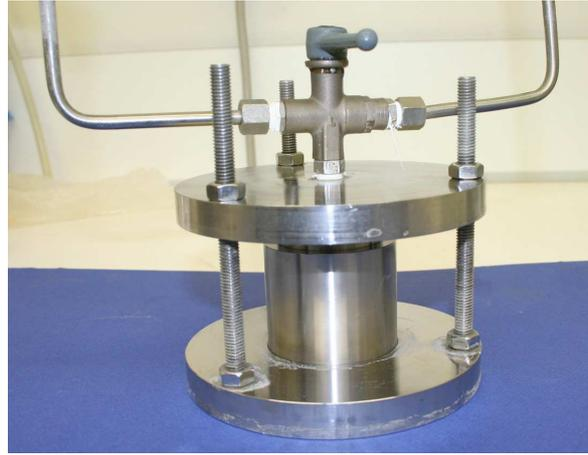
FIG. 3.4 – Cellule de déséquilibre thermodynamique.
