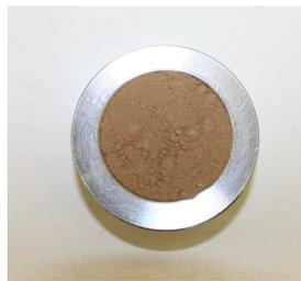
FIG. 3.5 – Echantillon de sol dans son porte-échantillon.
