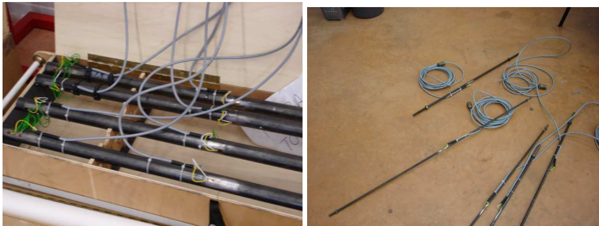
Figure 46. Montages de jauges montés sur les différents éléments de la minigrille.
