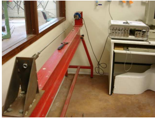
Figure 47. Banc de tension pour l'étalonnage des tirants.
