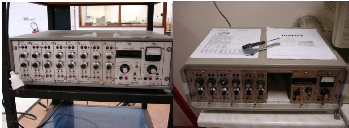
Figure 50. Conditionneurs Vishay utilisés pour les mesures d'efforts.
