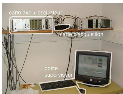
Figure 34. Dispositif d'acquisition des données, instrument virtuel Labview.
