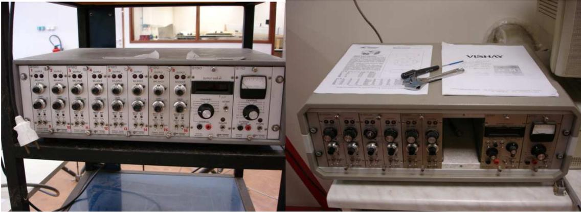
Figure 50. Conditionneurs Vishay utilisés pour les mesures d'efforts.
