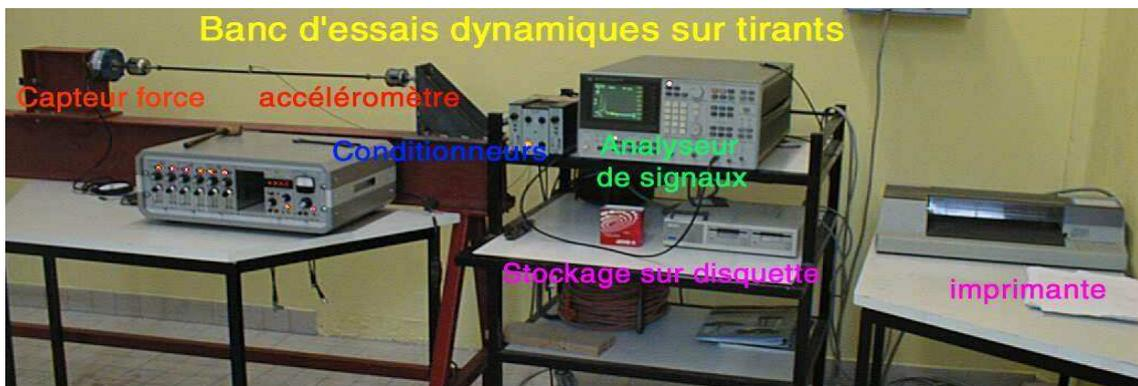
Figure 23. Dispositif d'étalonnage des mesures de tension des tirants.
