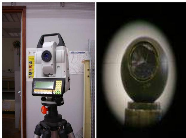
**Figure 53. Vue du tachéomètre, visée d'un coin cube.**
