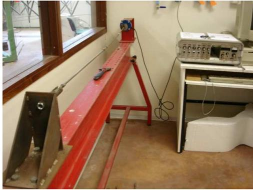
Figure 47. Banc de tension pour l'étalonnage des tirants.
