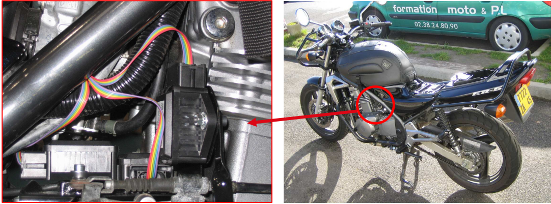
Figure 12 : Placement des trois gyromètres en trièdre sur la moto expérimentale
