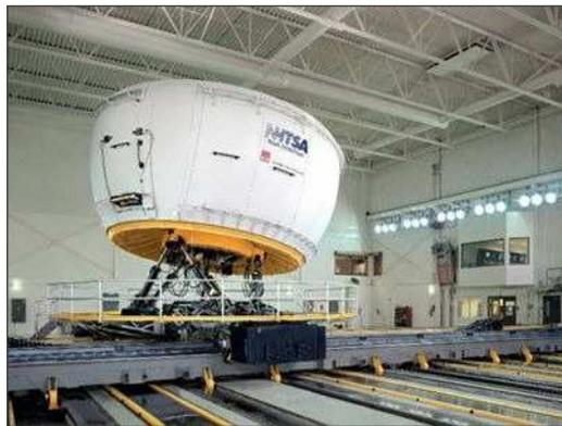
Figure 57 : Le simulateur de conduite automobile NADS (*National Advanced Driving Simulator*) de l'Université de l'Iowa aux États-Unis
