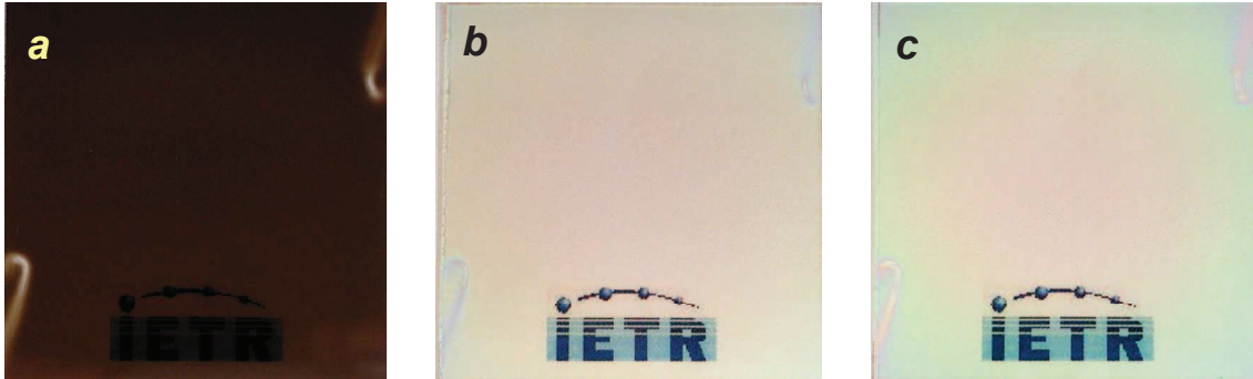
figure II-19 : aspects visuels de trois couches d'ITO sur verre Corning 50x50 mm 2 : a) couche très déficiente en oxygène conductrice et noire, b) couche optimisée, c) couche peu déficiente en oxygène isolante et transparente. Le logo IETR est vu par transparence
