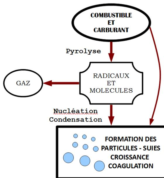
FIGURE 1.1 – Mécanisme simplifié de formation des suies
