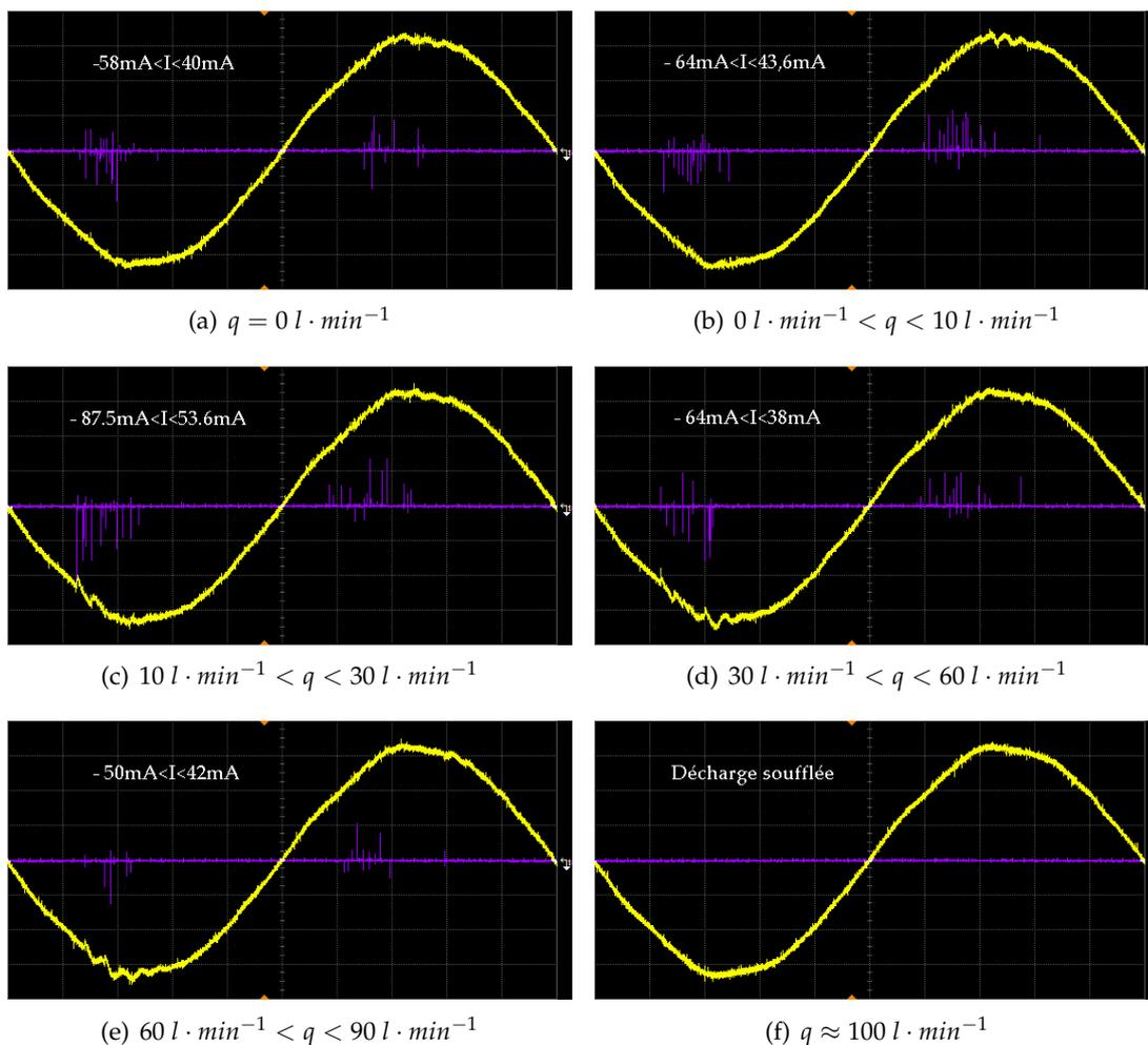
FIGURE 4.7 – Oscillogrammes de tension et de courant en géométrie cylindre-cylindre avec diélectrique en quartz pour différentes valeur de débits de gaz  $0 < q < 100 \text{ l} \cdot \text{min}^{-1}$ ;  $U_{eff} = 12,3 \text{ kV}$  et  $f = 50 \text{ Hz}$ ;  $\Delta y_{jaune} = 5 \text{ kV/div}$ ,  $\Delta y_{violet} = 40 \text{ mA/div}$ ,  $\Delta x = 2 \text{ ms/div}$
