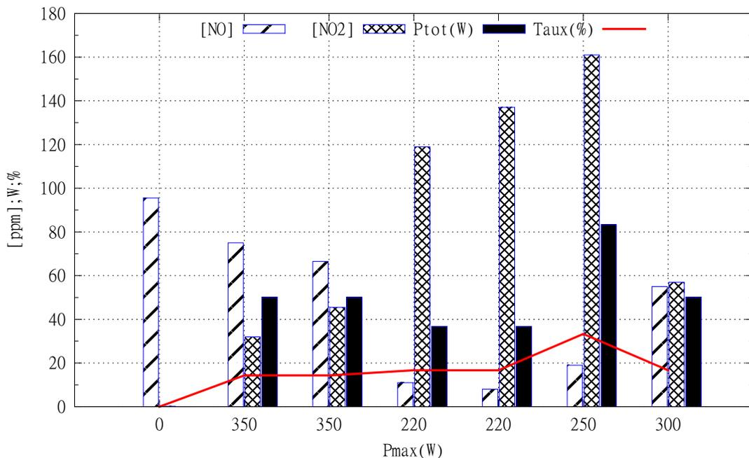
FIGURE 4.13 – Oxydation des NOx en géométrie cylindre-cylindre avec barrière diélectrique en quartz, source alternative G2000, débit  $q \approx 30 \text{ l} \cdot \text{min}^{-1}$  et  $40 \text{ l} \cdot \text{min}^{-1}$
