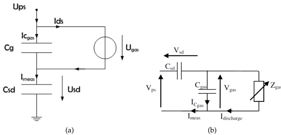
FIGURE 2.6 – Schémas électriques équivalents à un réacteur avec barrière diélectrique : (a) Représentation de la phase de décharge comme une source [8]; (b) Représentation avec impédance équivalente ( $Z$ ) de la phase de décharge [9]
