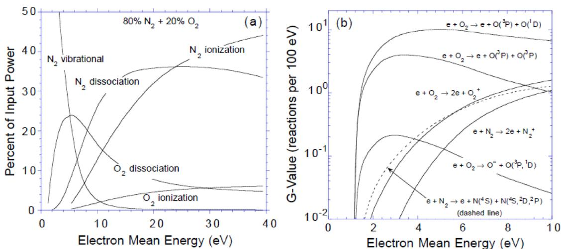
FIGURE 2.5 – (a) Puissance consommée lors d'un processus collisionnel conduisant à des états vibratoires, excités, dissociés et ionisés de N<sub>2</sub> et O<sub>2</sub>. (b) G-values calculées pour la dissociation et la ionisation dans de l'air sec, en fonction de l'énergie moyenne des électrons dans un plasma de décharge [7]
