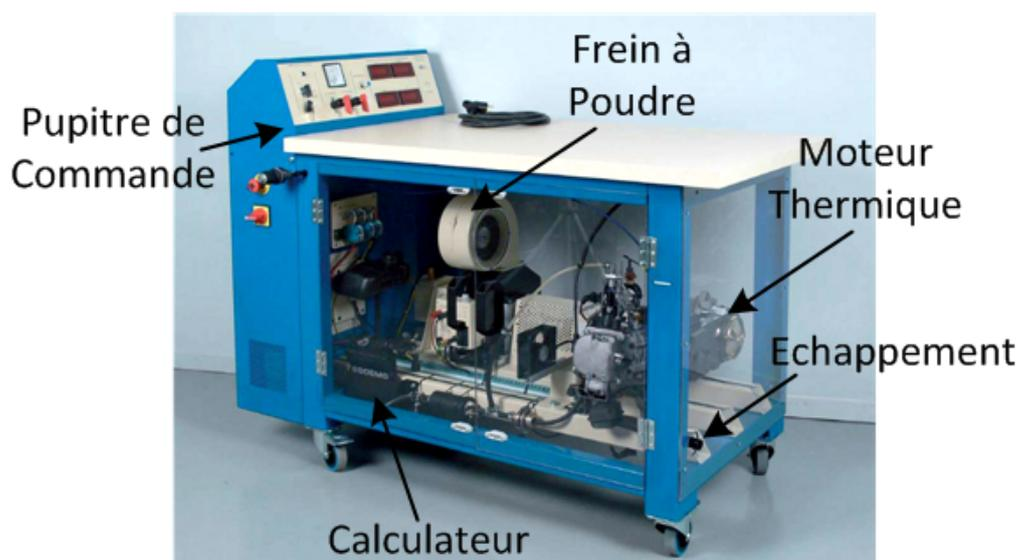
FIGURE 3.33 – Banc Moteur Langlois VL11 monocylindre - 4 temps - 50 cm<sup>3</sup>
