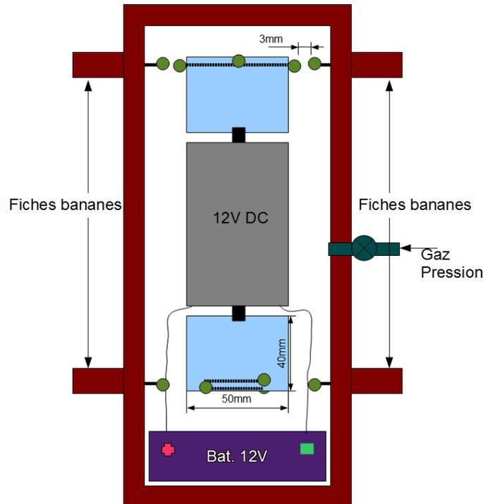
FIGURE 3.10 – Schéma du Rotary Spark Gap
