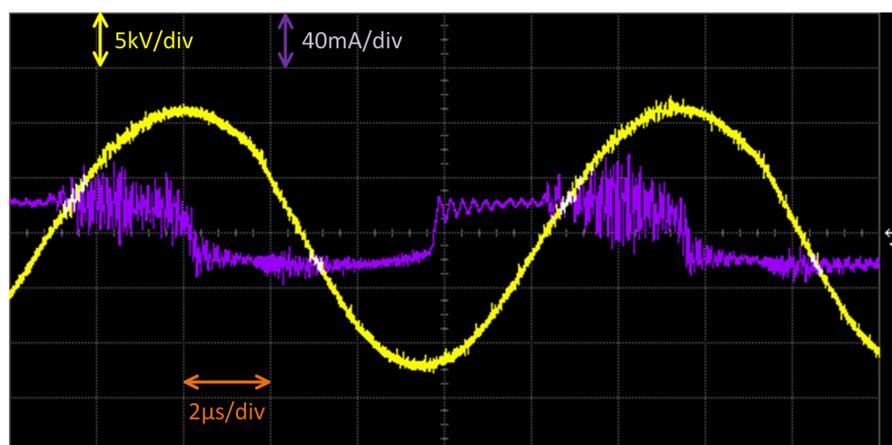
FIGURE 4.9 – Oscillogrammes de tension et de courant obtenus avec le G2000 pour la géométrie cylindre-cylindre comportant un diélectrique en quartz;  $U_{eff} = 8 \text{ kV}$  et  $f = 99 \text{ kHz}$ ,  $\Delta y_{jaune} = 5 \text{ kV/div}$ ,  $\Delta y_{violet} = 40 \text{ mA/div}$ ,  $\Delta x = 2 \text{ µs/div}$
