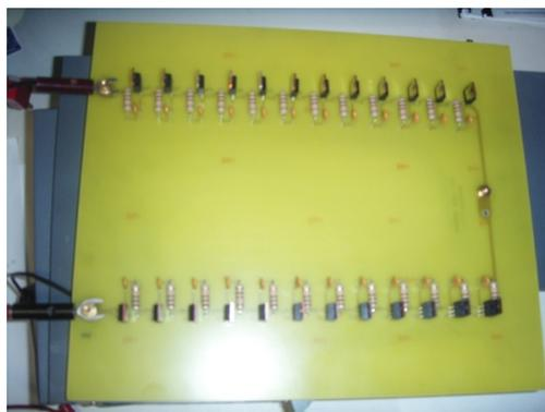
FIGURE 3.4 – Plaque de semi-conducteurs 20 kV
