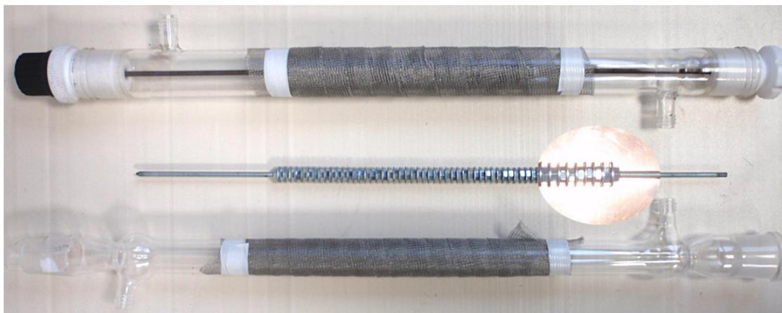
FIGURE 3.19 – Réacteurs disque-cylindre et Liebig (2 diélectriques)
