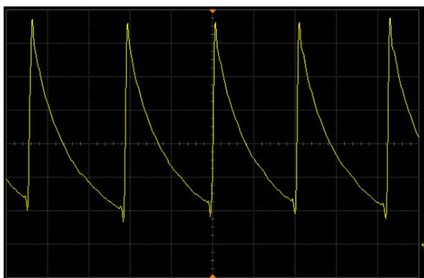
FIGURE 3.9 – Oscillogramme de tension correspondant au montage de la figure 3.8 avec  $U_{DC} = 15 \text{ kV}$   $C_{réacteur} = 100 \text{ pF}$  et  $R_0 = 100 \text{ M}\Omega$  -  $\Delta x = 50 \text{ ms/div}$  ;  $\Delta y = 2 \text{ kV/div}$
