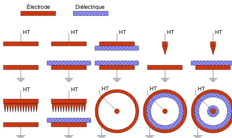
FIGURE 2.4 – Différentes configurations d'électrodes pour la génération de plasmas froids
