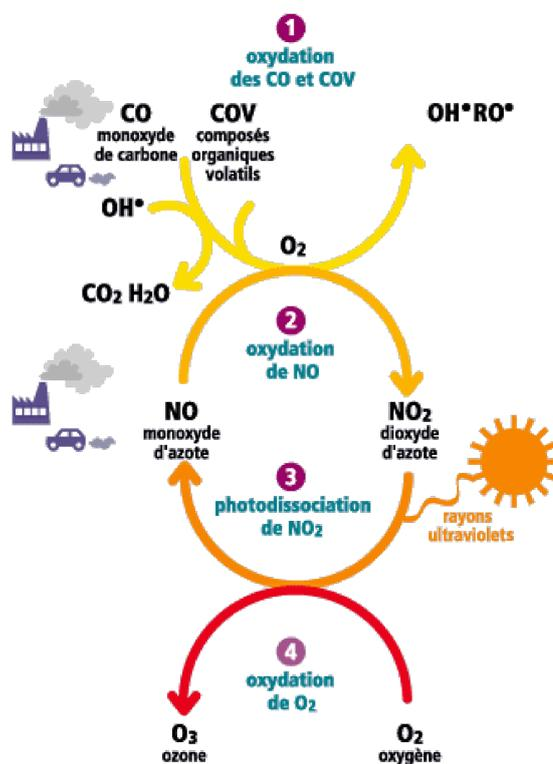
FIGURE 1.2 – Mécanisme simplifié de la formation de l’ozone dans l’atmosphère sous l’influence de la présence de  $NO_x$  et de  $COV$  [Drire]
