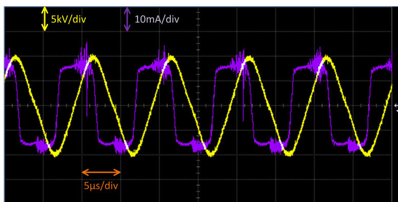
FIGURE 4.4 – Oscillogrammes de tension et de courant pour le réacteur fil-cylindre avec barrière alimenté par le G2000 avec f = 99 \text{ kHz} , \Delta y_{\text{jaune}} = 5 \text{ kV/div} , \Delta y_{\text{violet}} = 10 \text{ mA/div} , \Delta x = 5 \mu\text{s/div}
