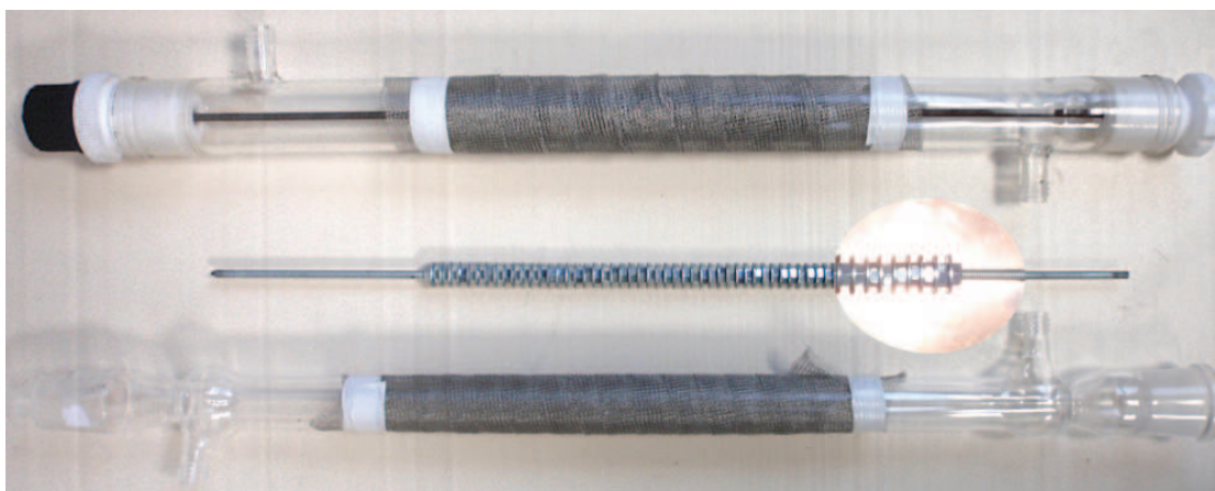
FIGURE 3.19 – Réacteurs disque-cylindre et Liebig (2 diélectriques)
