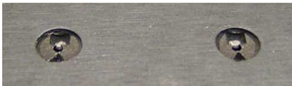
FIGURE 2.16 – Deux exemples de moule de la «patte» en nitrile des SPP. Le diamètre du moule est de 4 mm.
