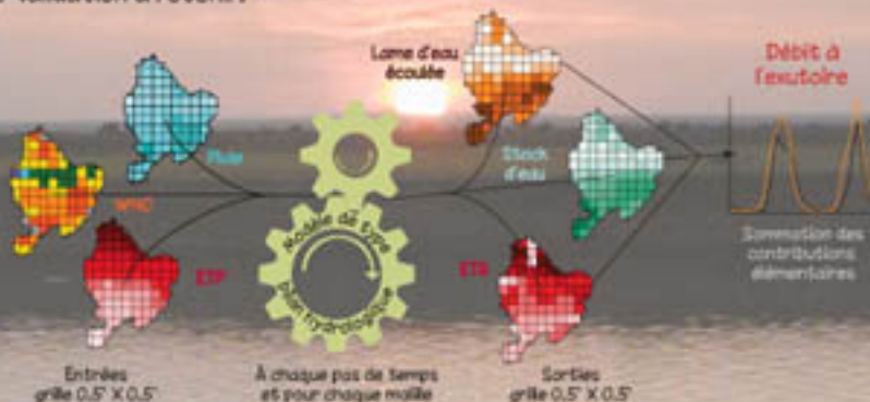
Schéma du fonctionnement de la modélisation pluie-débit employée WHC = capacité en eau du sol, ETP = évapotranspiration potentielle, ETR = évapotranspiration réelle.
