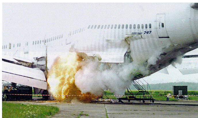
FIGURE 2.4 – Essai au sol d’une explosion dans la soute d’un boeing 747 [6].
