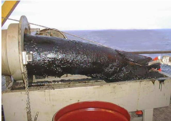
**Photo 2 – Extraction du dépôt de cire formé dans un conduit de transport.**
