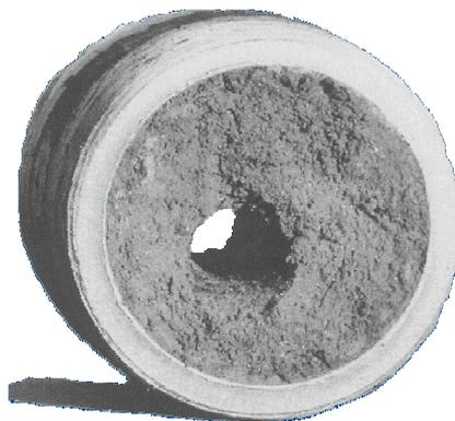
**Photo 1 – Dépôt de cire dans un conduit de transport.**
