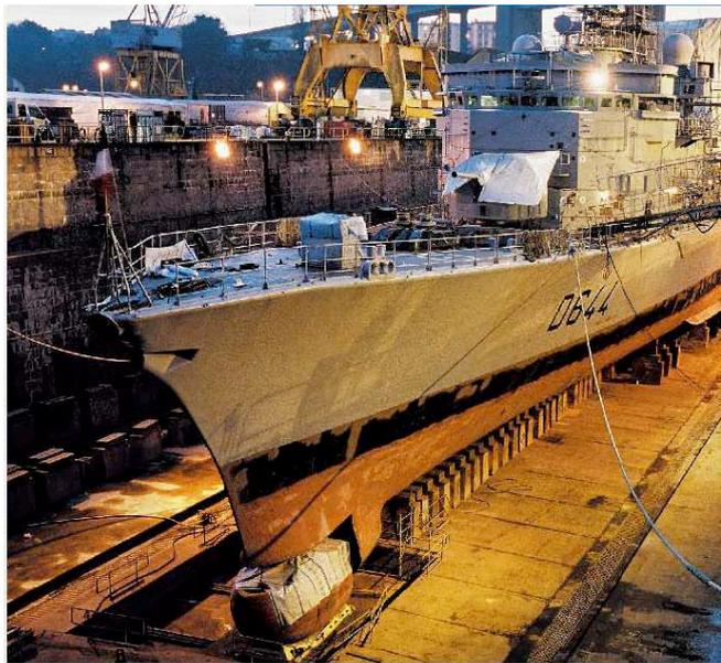
FIGURE 1.10 – Vue de la partie du bulbe d'étrave en composite de la frégate anti-sous-marine Primauguet (source : Naval Experts de Juin 2009, magazine externe de DCNS).
