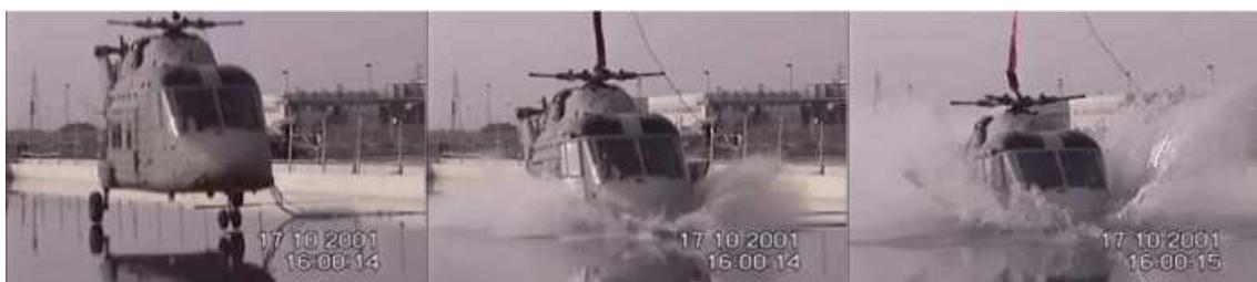
FIGURE 1.8 – Essai d'impact sur l'eau en chute libre d'un hélicoptère ([Toso \(2009\)](#)).
