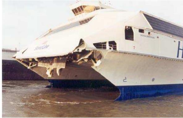
FIGURE 1.2 – Endommagement du catamaran à grande vitesse HSS 1500 Stena suite à un impact hydrodynamique de type *wetdeck slamming* (Lavroff *et al.* (2010)).
