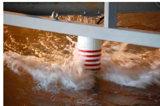
FIGURE 1.6 – Essais d'impacts de vagues sur une structure cylindrique circulaire verticale (Zang *et al.* (2010)).
