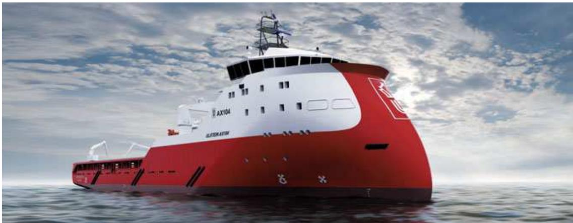
FIGURE 1.3 – Concept d'étrave X-bow pour réduire les effets du slamming (source : <http://www.ulsteingroup.com>).
