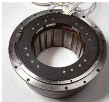
Figure I.5 Stator d'un centreur magnétique
