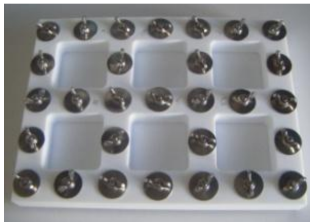
Figure (III-14) : Moule de préparation des films nanocomposites
