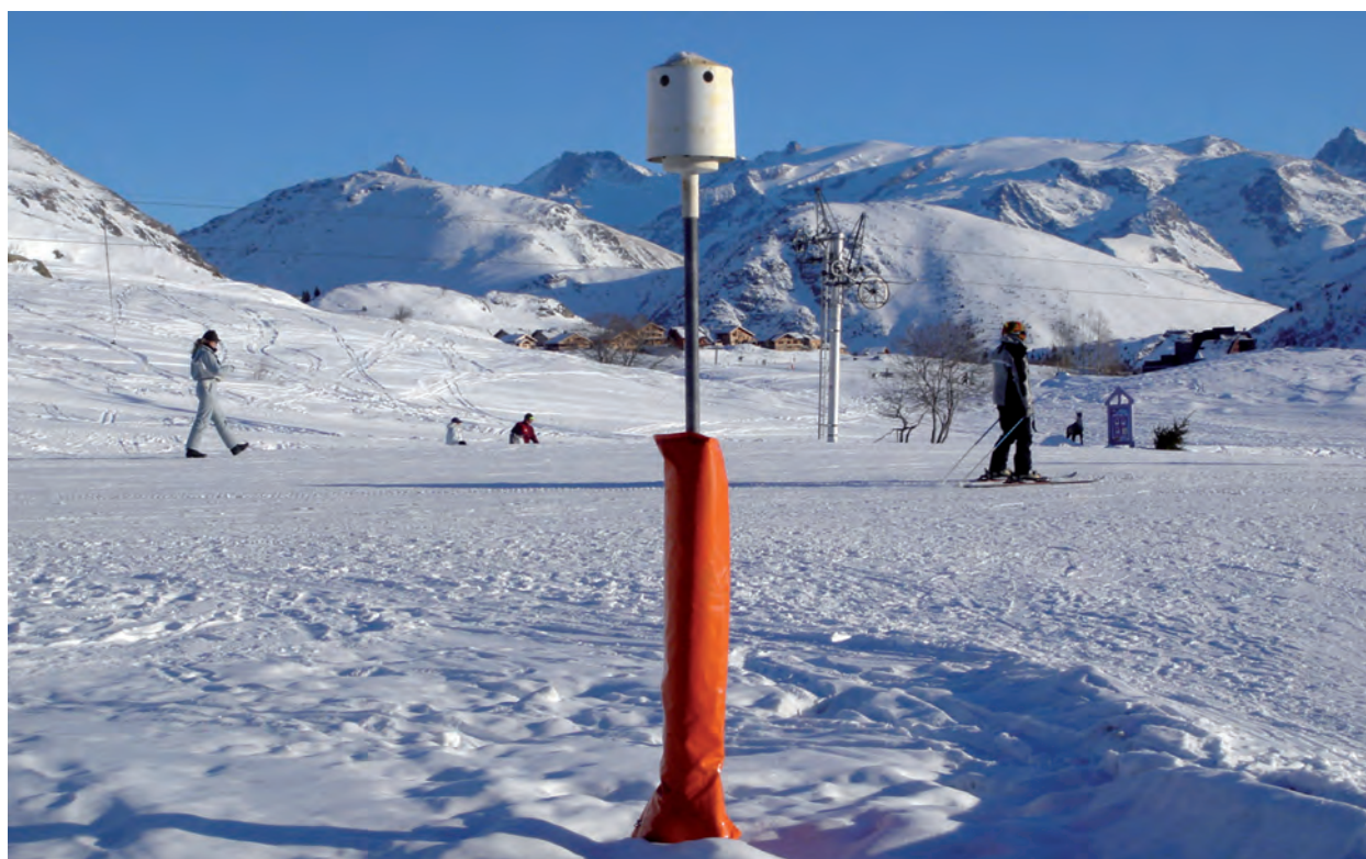
Photo 3.18 : Une des sondes (sous abri) du réseau de production de neige de l'Alpe d'Huez, Isère (cliché : P. Paccard, le 03/01/2009). En arrière plan, le glacier du Mont de Lans (domaine skiable des Deux Alpes).
