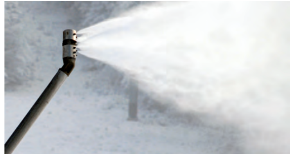
Photo 3.14 : Tête d'enneigeur bi-fluide à mélange externe (cliché : P. Paccard, le 15/12/2009)
