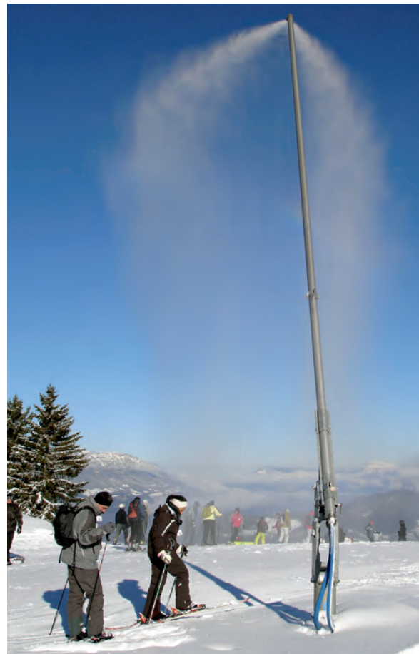
Photo 3.12 : Enneigreur bi-fluide en fonctionnement (cliché : Y. Deschaux, le 07/12/2008, Les Sept-Laux, Isère)
