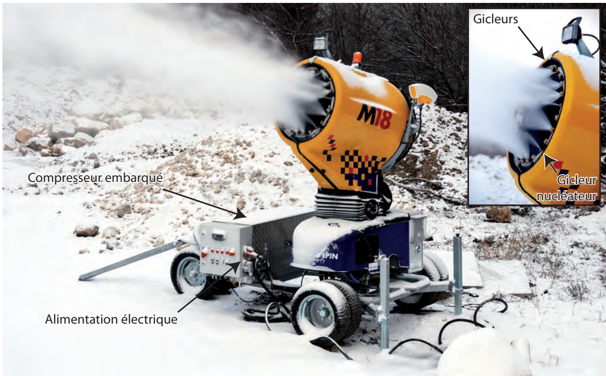
Photo 3.11 : Enneigreur mono-fluide en fonctionnement (enneigreur multigicleurs de section fixe montés sur couronnes, Saint-Pierre-de-Chartreuse, Isère) (cliché : P. Paccard, le 15/12/2009)
