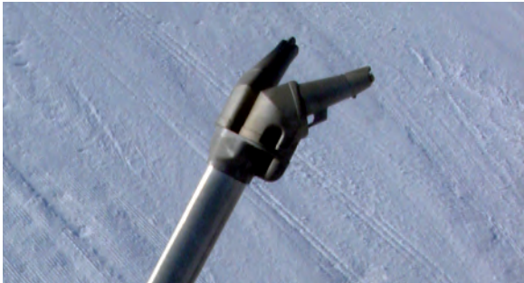
Photo 3.13 : Tête (double) d'enneigeur bi-fluide à mélange interne (cliché : P. Paccard, le 05/04/2009)
