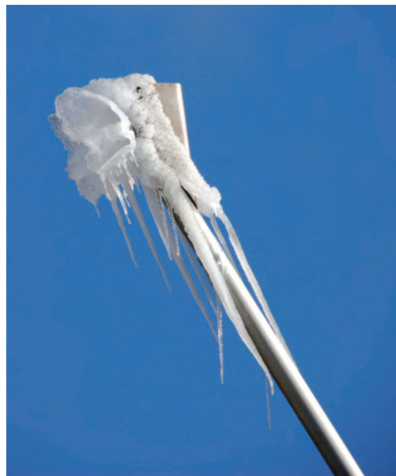
Photo 3.20 : Bouchon de glace formé sur la tête d'un enneigeur par un vent contraire au sens de production (cliché : P. Paccard, le 15/12/2009, Villard-de-Lans, Isère)
