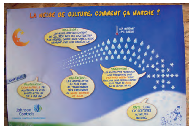
Photo 4.3 : Panneau d'information sur le principe de production de neige à proximité de l'usine à neige de Flaine, Haute-Savoie (cliché : Y. Gosseume, le 21/02/2009).
