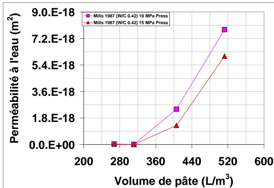
Figure 5.15- Perméabilité intrinsèque de bétons pour une qualité constante de pâte (E/C= 0.42) et un volume de granulats variable. La pression d'eau est de 1.38MPa pour deux pressions latérales de 10MPa et 15MPa.
