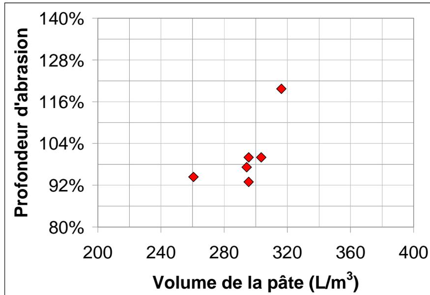
Figure 4.21- Volume de pâte vs Résistance à l'abrasion d'après Dhir, Hewlett Chan. [14]
