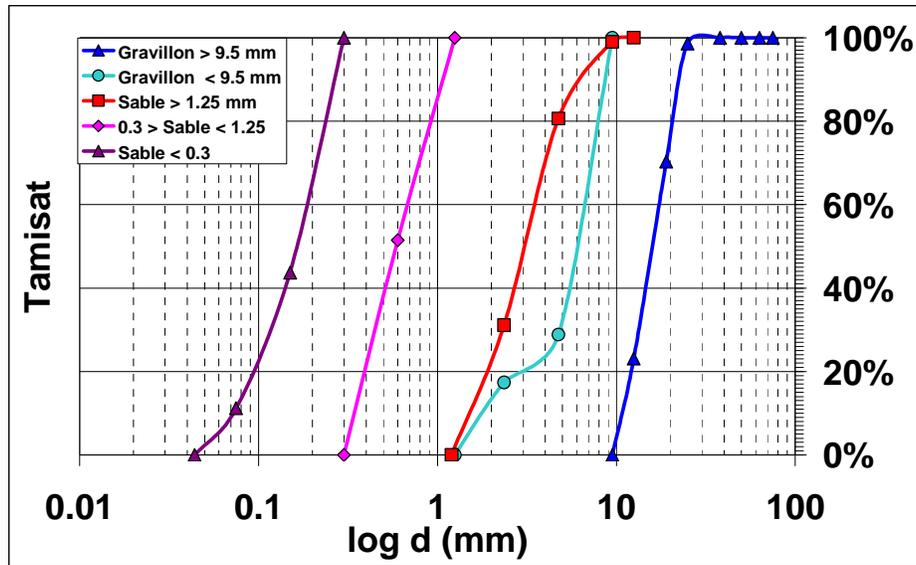
Figure 6.21-Distribution granulaire des cinq fractions de granulats analysées
