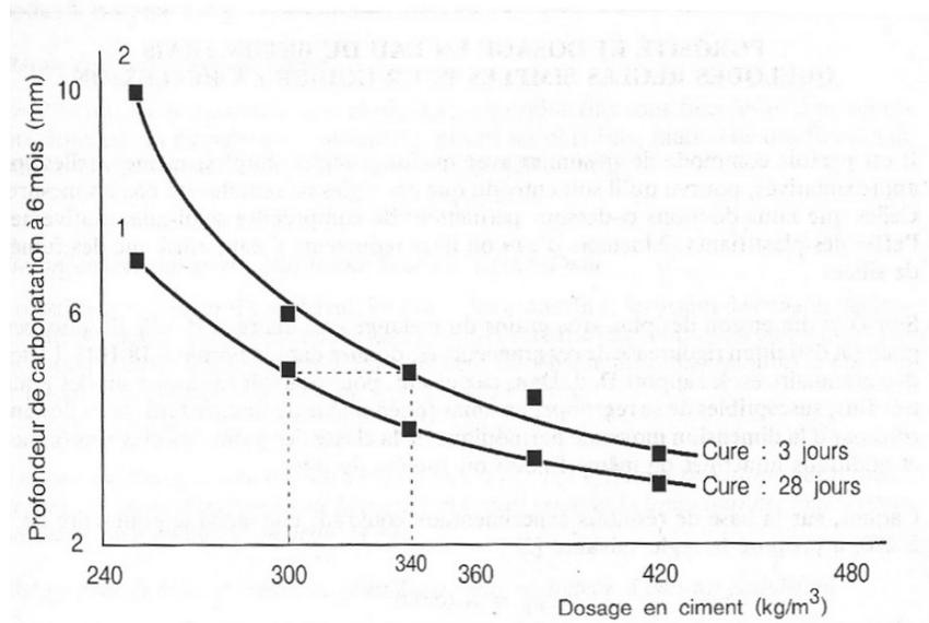
**Figure 5.10-** Comparaison entre bétons avec différents contenus de ciment vs profondeur de carbonatation. Cette comparaison est affectée par le rapport eau/ciment étant donné que ces bétons ont un E/C différents pour préserver la maniabilité dans le cône d'Abrams (plus de ciment, moins de E/C) [144]
