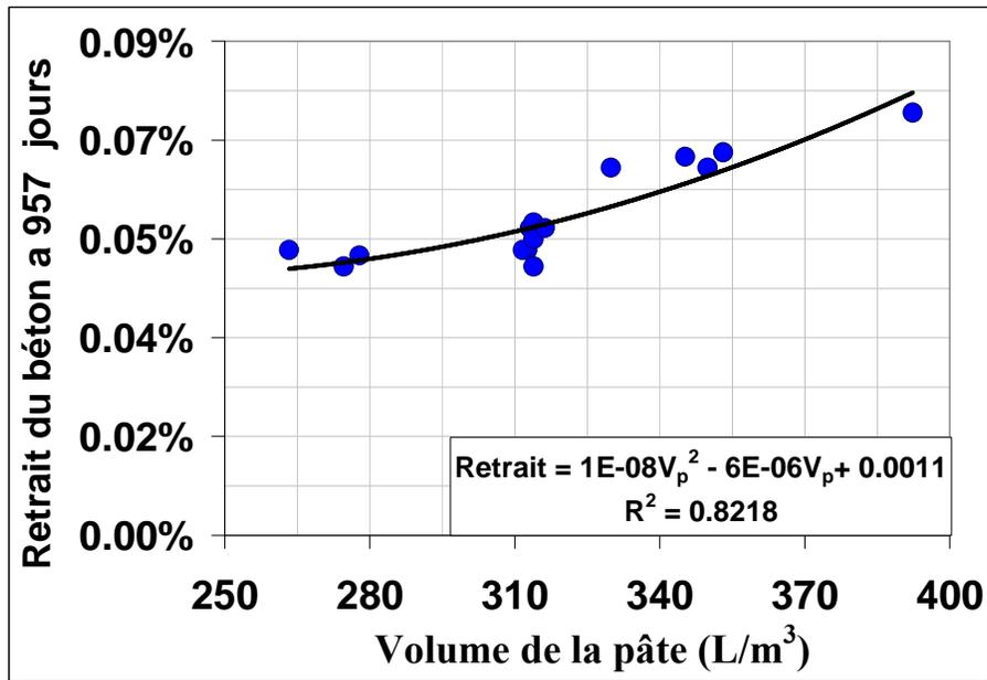
**Figure 4.18-** Retrait du béton à 957 jours (2.6 ans) vs. Volume de pâte/m<sup>3</sup> [13]. ASTM C 157 échantillons 10\*10\*28.5 cm (HR 65%± 5% T 21 ° C± 2 ° C (E/C constant 0.46)).
