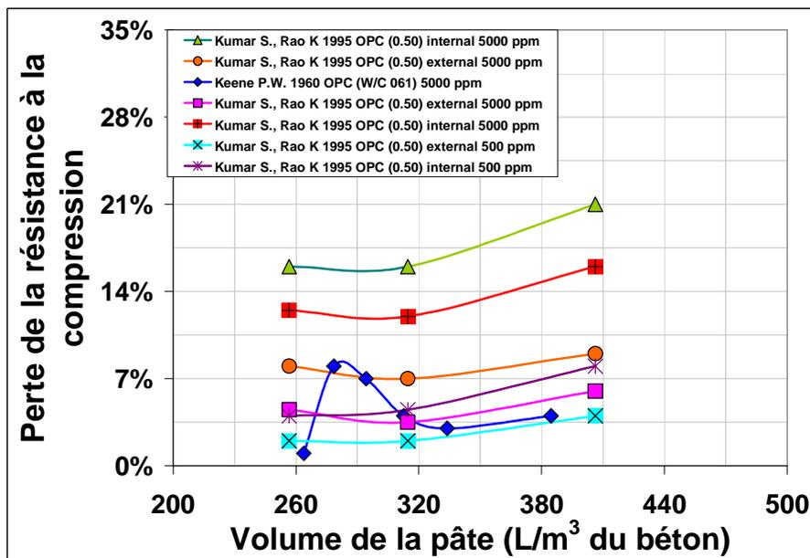
**Figure 5.32-** Perte de résistance à la compression après l'attaque de sulfates en fonction du volume de pâte. Les sulfates proviennent de la composition initiale (interne) ou de contact permanent avec le béton durci (externe). [159-160]
