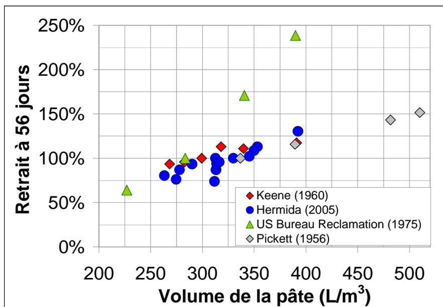
**Figure 4.19-** Volume de pâte vs Retrait du béton à 56 jours à partir de données de différents auteurs [13, 67,68], Les données sont normalisées par la valeur de retrait mesurée pour 300 L/m<sup>3</sup> spécimens de géométrie similaire. (E/C constant).
