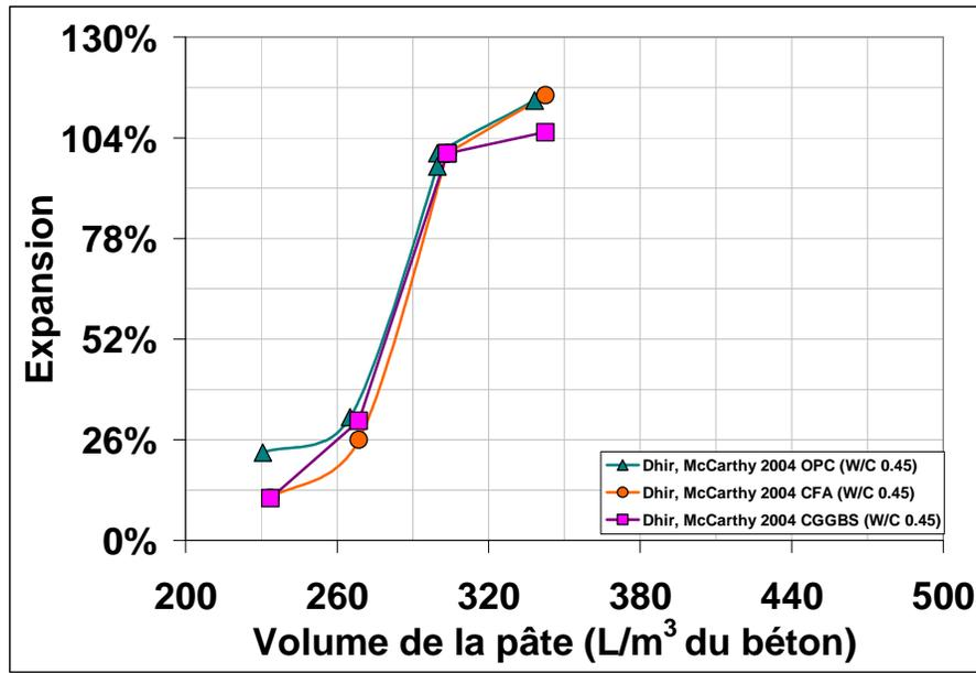
**Figure 5.31-** Expansion de poutrelles après une année d'exposition à une solution de 5% de  $Na_2SO_4$  en fonction du volume de pâte et en termes relatifs quand la valeur de 300 L/m<sup>3</sup> de pâte correspond à une valeur de 100% [56].
