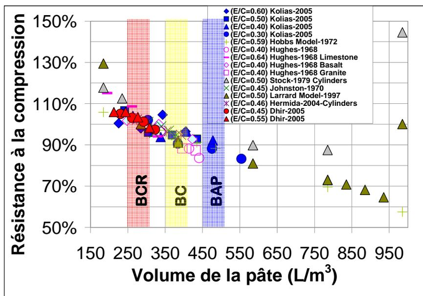
**Figure 4.12-** Résultats expérimentaux et modèles Larrard et Hobbs sur l'existence d'un volume de pâte critique (ou volume de granulats critique) pour lequel on atteint la résistance minimale pour une qualité de pâte constante. Contenu de pâte usuel pour Béton Compacté au Rouleau (BCR), Béton Conventionnel (BC), Béton Autoplaçant (BAP). Chaque série de données est normalisée par rapport à sa valeur moyenne à 300 L/m<sup>3</sup>.
