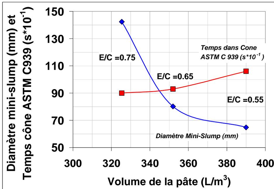
Figure 6.4- Consommation de pâte face à la valeur de mini-slump et temps d'écoulement dans le cône ASTM C 939 (indicateur de viscosité) pour les pâtes évaluées (0.75, 0.65 et 0.55 de E/C)
