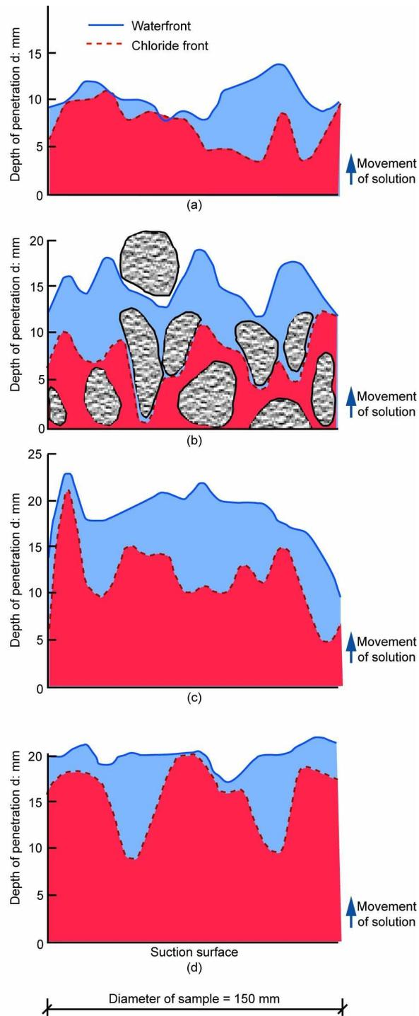
**Figure. 5.2-** Avancement des fronts d'eau et chlorures par capillarité dans le béton, en mm .
