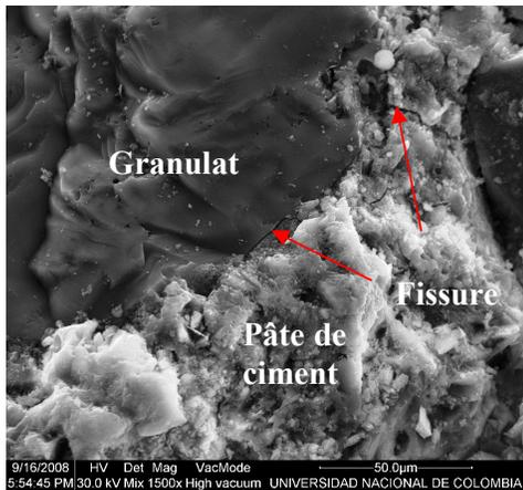
**Photo 5.** Fissure au contact pâte-granulat SIX-1 (x1500)
