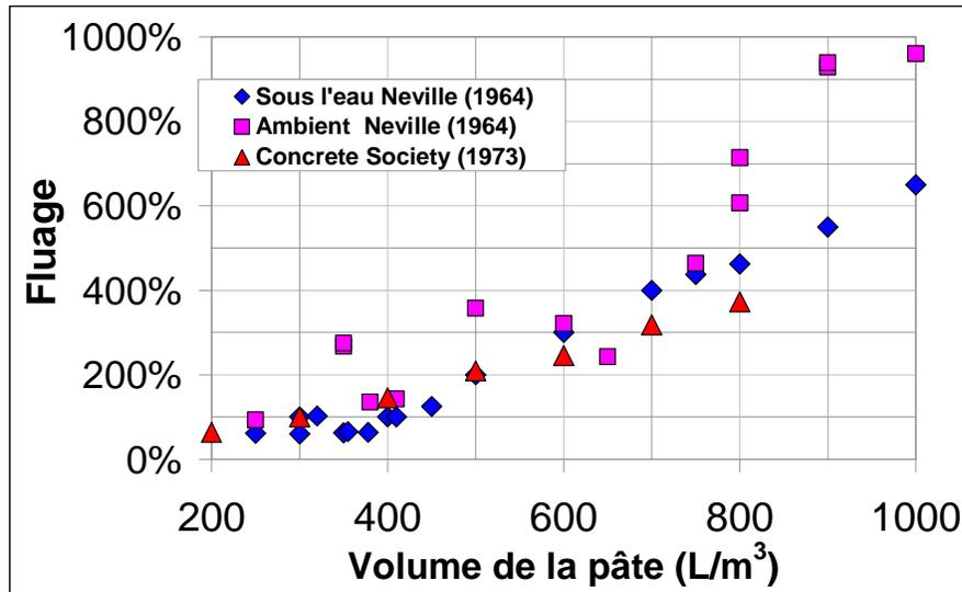
**Figure 4.20-** Volume de pâte vs Fluage d'après Neville et la Concrete Society technical. [41, 69], tant à l'état humide que sec à 60 jours sous des efforts égaux à 0.5 fois la résistance et une application de la charge à 14 jours.
