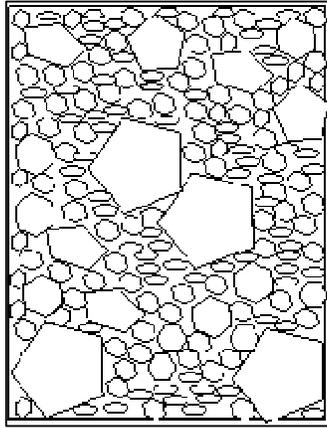
**Fig 4.3 - Arrangement de granulat sans pâte.**
