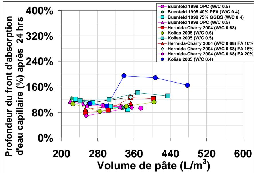
*Figure 5.22- Volume de pâte vs Profondeur du front de l'absorption capillaire d'eau après 24 heures d'immersion de spécimens de béton cylindriques de diamètre 100 mm..où l'on prend pour 100% la profondeur obtenue pour un volume de pâte de 300 L.*
