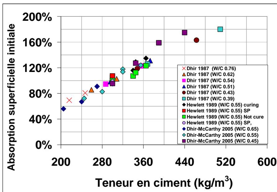
Figure 5.25- Concentration de ciment vs Absorption Initiale de surface (ISAT-10) % pour des séries à relation E/C constante. La valeur ISAT-10 correspondant à 300 kg/m<sup>3</sup> a été prise à 100%.
