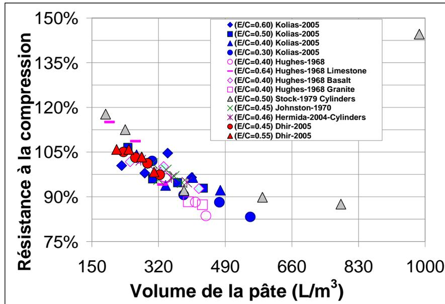
*Figure 4.11- Volume de pâte vs. Résistance à la compression à partir de données de différents auteurs exprimées en pourcentage où 100% de la résistance correspondent à un volume de pâte de 300 L/m<sup>3</sup>.*
