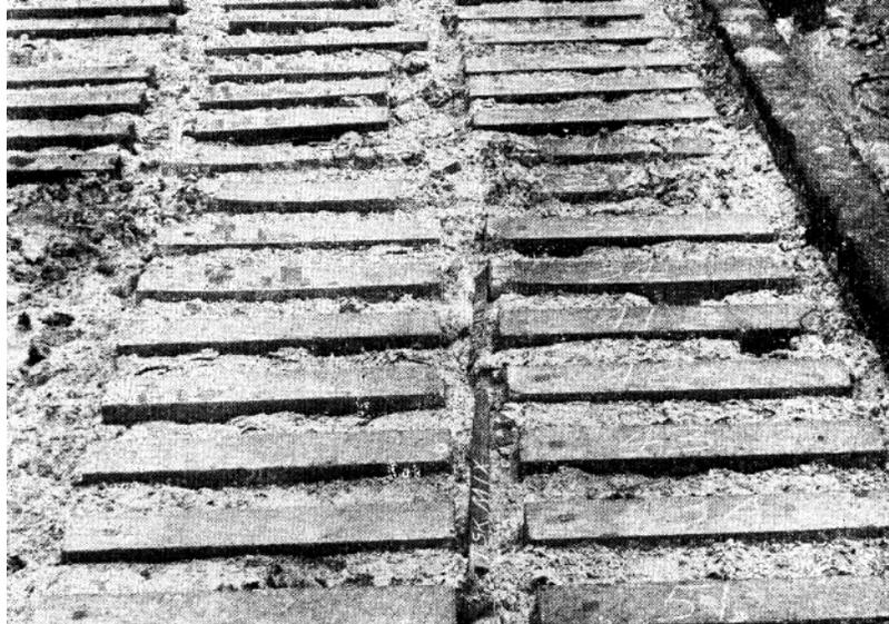
*Figure 5.5-Condition de poutrelles après dix années d'exposition à un sol riche en sulfates (10%  $\text{Na}_2\text{SO}_4$ ) essais de longue durée de la PCA, 1952. [130]*
