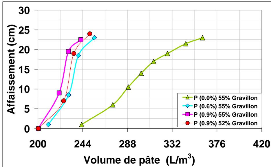
**Figure 6.19-** Consommation de pâte  $E/C = 0.65$  pour différentes doses d'adjuvant et différents niveaux de maniabilité. Série VII. (Ciment CPR)  $T 20\text{ }^{\circ}\text{C}$ - 65% HR avec l'optimum expérimental.
