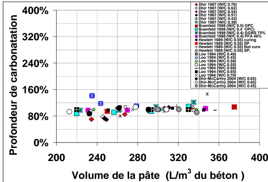
*Figure 5.12- Relation entre le volume de pâte (Volume de ciment + Volume d'eau libre) et la profondeur de carbonatation accélérée et naturelle par différents auteurs où 300 L de pâte correspondent à une profondeur du 100%.*
