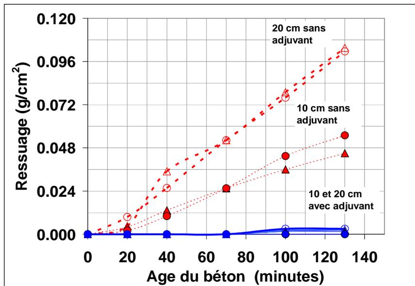
**Figure 6.16-**Ressuage cumulé (g/cm<sup>2</sup>) pour deux niveaux de maniabilité sans adjuvant - hauts contenus de pâte et deux niveaux de maniabilité pour bétons à faible volume de pâte et fort dosage en adjuvant. ASTM C 232 Procédé A
