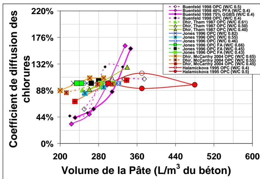
Figure 5.29-Coefficients de diffusion obtenus par différents auteurs pour des bétons à égale qualité de pâte mais différents contenus volumétriques de celle-ci, en termes pourcentages par rapport au Dff du béton avec 300 L/m³.
