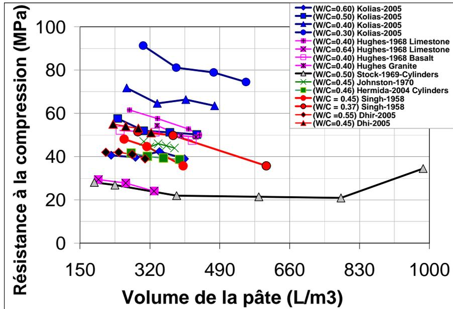
Figure 4.10- Effet du volume de pâte sur la résistance à la compression du béton à partir de résultats de différents auteurs.
