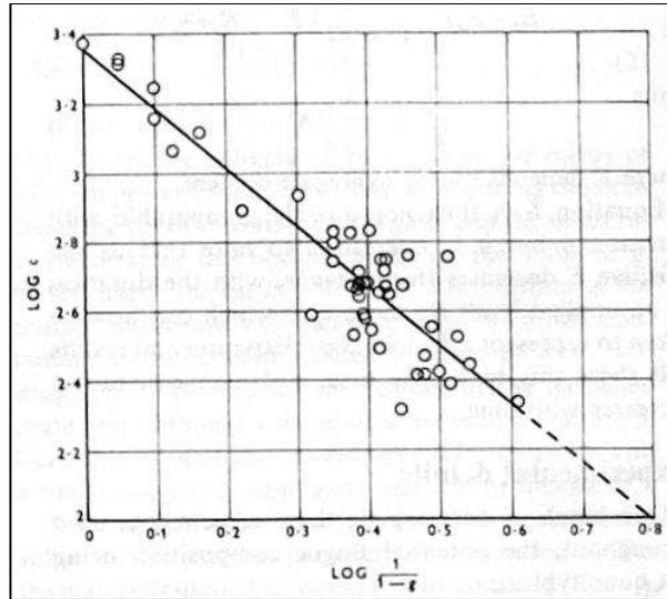
**Figure 4.5-** Relation entre le fluage  $\epsilon$  à 28 jours sous charges et un contenu de granulats  $g$  pour des spécimens stockés dans des conditions humides et chargés à l'âge de 14 jours (contrainte/résistance de 0.5). [40]
