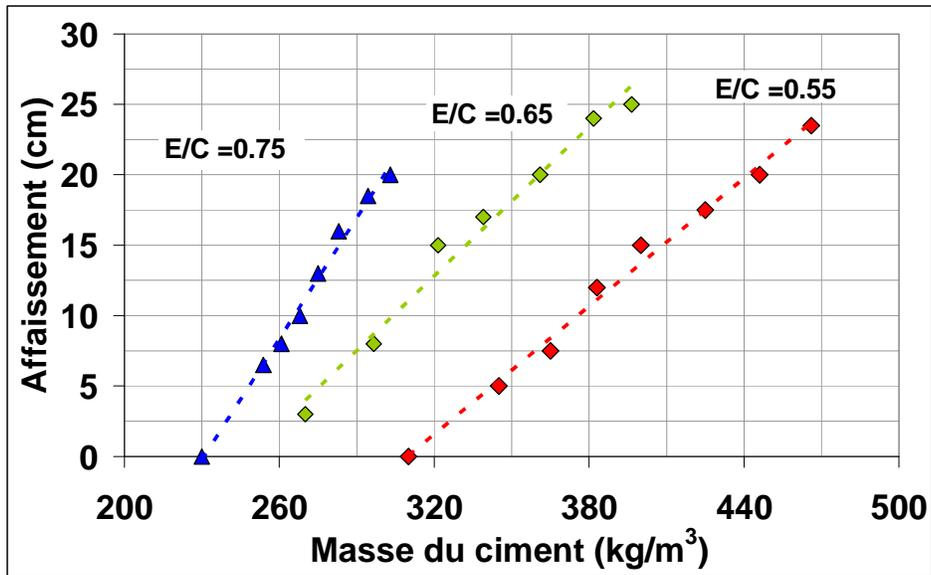
**Figure 6.3-**Consommation de ciment face à l'affaissement pour différentes qualités de pâte (E/C), Série I. Sensibilité de la concentration en ciment vs. Affaissement (ciment CPR) T 20 ° C ± 2 ° C, HR 65%±5%
