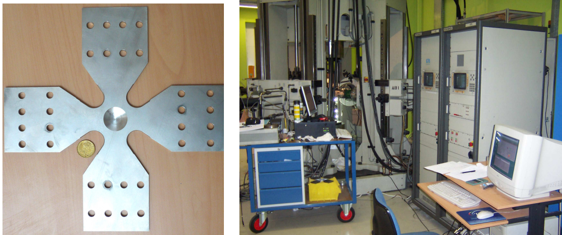
FIGURE 2.9: Vue de l'éprouvette biaxiale 304L avec sa géométrie finale. Vue d'ensemble de la machine triaxiale ASTREE.
