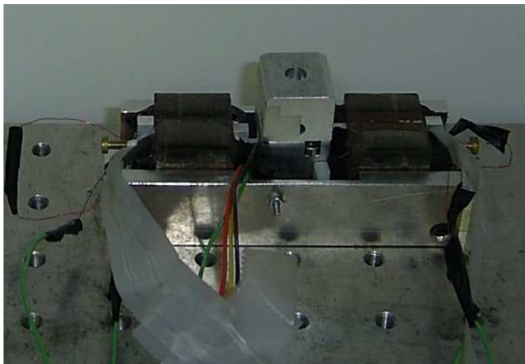
FIG. 4.13 – Photographie de l'actionneur push-pull utilisant des AMFM antagonistes.
