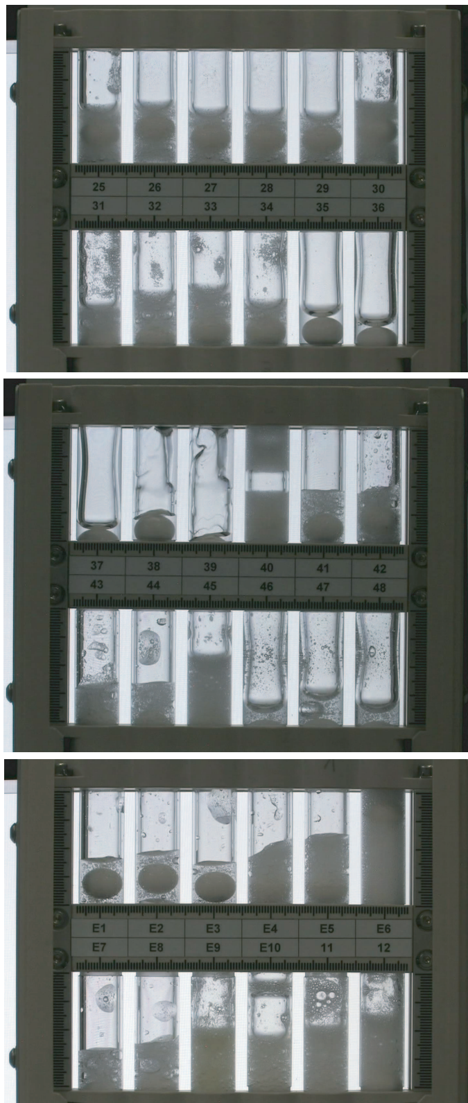
Figure III.2.36 – Exemple d'échantillons testés dans la Station Spatiale Internationale. Certains produits ne moussent pas et l'on peut constater que lorsque de la mousse se forme la fraction liquide est élevée. Crédit photo : ESA/NASA.
