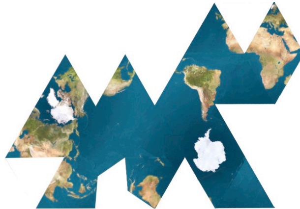
FIG. 1 – Projection de Fuller de la Terre (ou dymaxion) : projection cartographique de la Terre sur la surface d'un polyèdre. Cette projection créée par Richard Buckminster Fuller, en 1946, a l'avantage de ne pas déformer, ni de favoriser le Nord ou toute autre région du globe.
