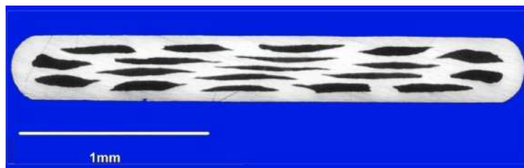
FIG. 4: Ruban composé de 19 filaments supraconducteurs.
