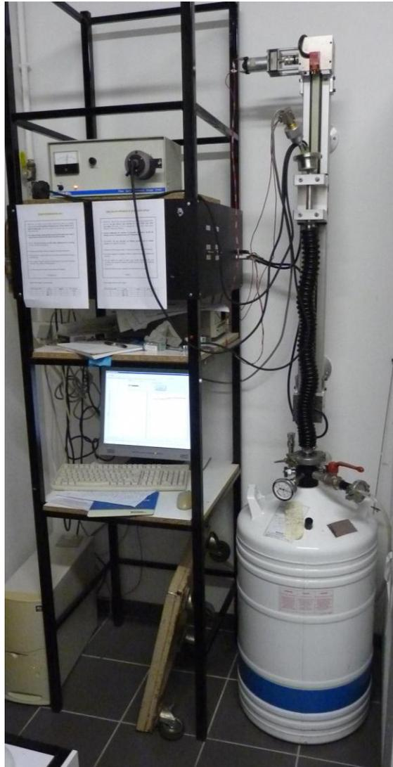
Figure 126 : Dispositif expérimentale de réflexion diffuse à basse température
