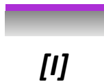
FIG. I.6: Schéma de l'étape d'énrésinage. Le substrat est représenté en gris et la résine en violet.
