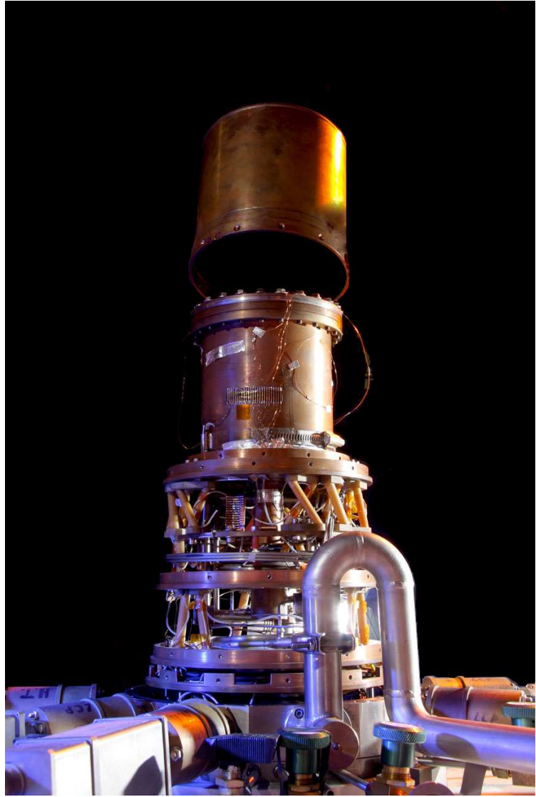
Figure 1.11 Photographie du cryostat Sionludi . On visualise les cinq étages sur lesquels sont fixés les écrans gigognes. L'écran en cuivre qui isole l'étage supérieur à 50 mK accueillant le microscope est visible sur ce cliché. La boîte de mélange en cuivre est en position centrale sous cet étage supérieur.
