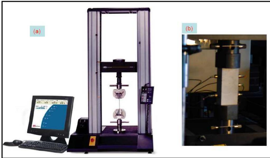
Figure 4.6. (a) Machine de traction/compression INSTRON 5569 avec le logiciel de pilotage Blue Hill [<http://www.instron.tm.fr>] ; (b) mise en place d'un échantillon.
