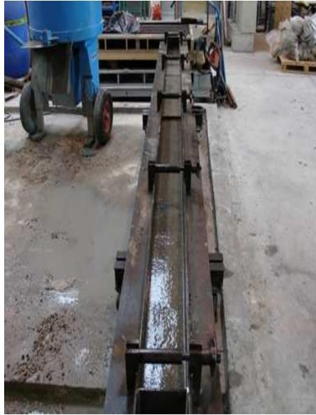
FIGURE 2.2 – Moule métallique pour former des poutres.
