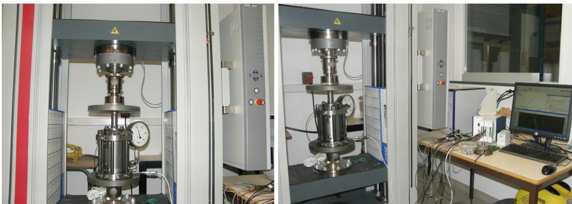
FIGURE 2.14 – Photographies de la cellule triaxiale mise en place sur la presse mécanique Instron<sup>TM</sup>, avec la carte d'acquisition National Instruments<sup>TM</sup>.
