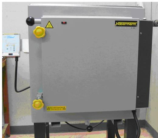
FIGURE 2.6 – Vue du four programmable Nabertherm<sup>TM</sup> utilisé pour les traitements thermiques sur mortier normalisé.
