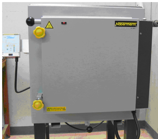
FIGURE 2.6 – Vue du four programmable Nabertherm TM utilisé pour les traitements thermiques sur mortier normalisé.
