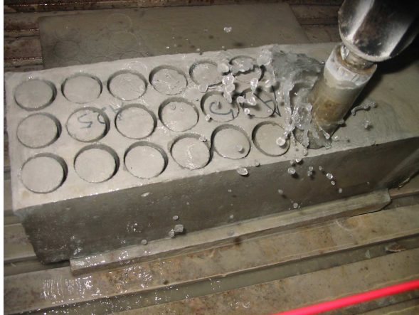
FIGURE 2.4 – Carottage des échantillons à un diamètre de 37 mm.
