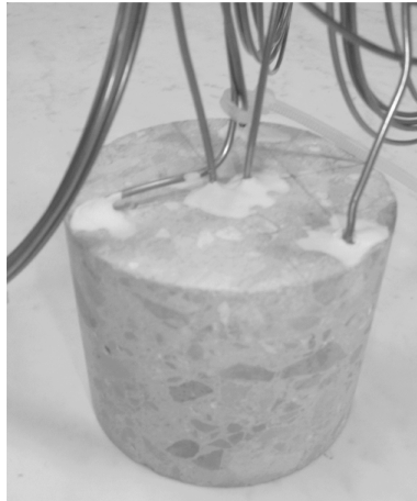
FIGURE 2.21 – Position des 5 thermocouples pour la vérification de l’homogénéité des températures dans l’échantillon (béton BAP Bathonien).
