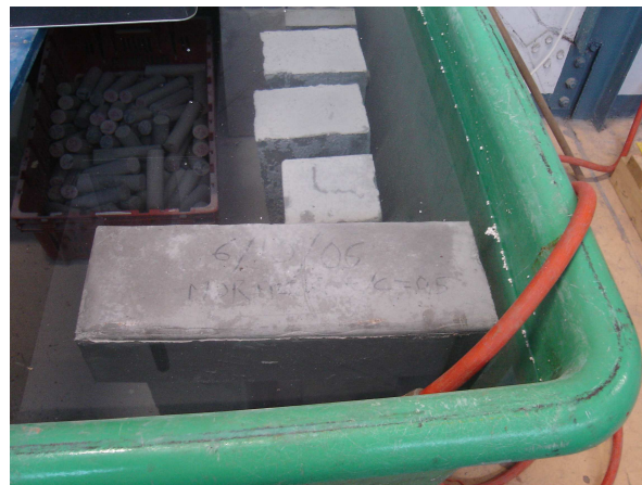
FIGURE 2.3 – Poutres en cure à l'eau ( 20^{\circ}\text{C} \pm 2^{\circ}\text{C} ).
