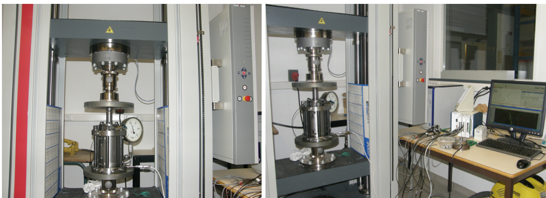
FIGURE 2.14 – Photographies de la cellule triaxiale mise en place sur la presse mécanique Instron TM , avec la carte d'acquisition National Instruments TM .
