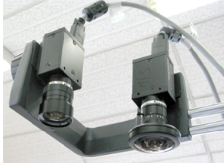
FIGURE 2.16 – Capteur stéréo mixte dans une seconde configuration avec une caméra fisheye sur la droite de l’image et une perspective sur la gauche.
