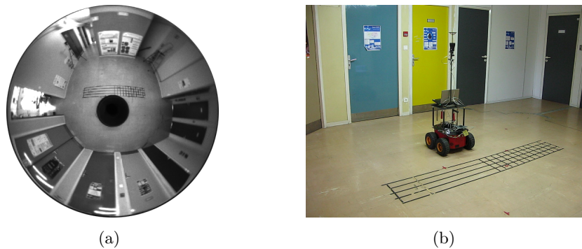
FIGURE 3.9 – Positionnement désiré. (a) l'image omnidirectionnelle acquise en cette position et (b) la vue externe du robot mobile en sa position désirée.
