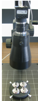
FIGURE 2.12 – Capteur FOO ( Four On One ) en utilisant l'optique de l'objectif catadioptrique de Remote Reality (Figure 2.10(a)).
