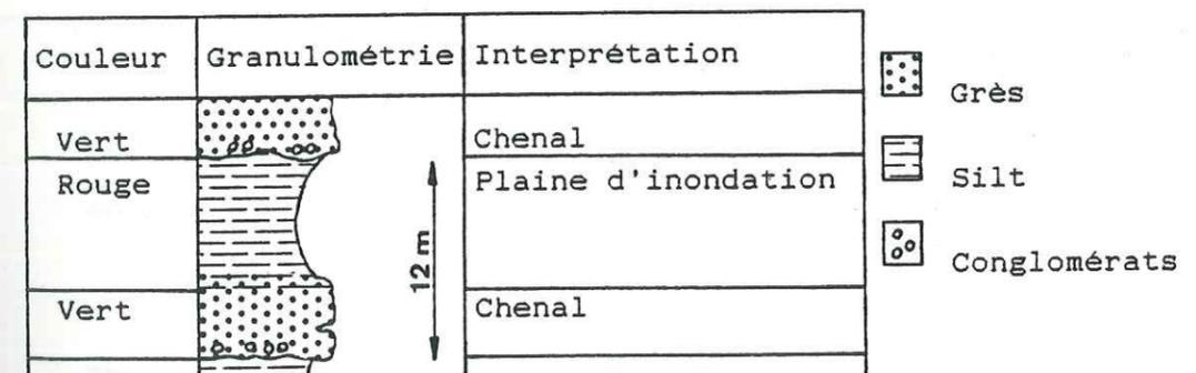
Fig.1.3. Relation entre la coloration verte et la coloration rouge dans une formation liée au phénomène d'oxydo-réduction (d'après FRIEND, 1966, simplifié).
