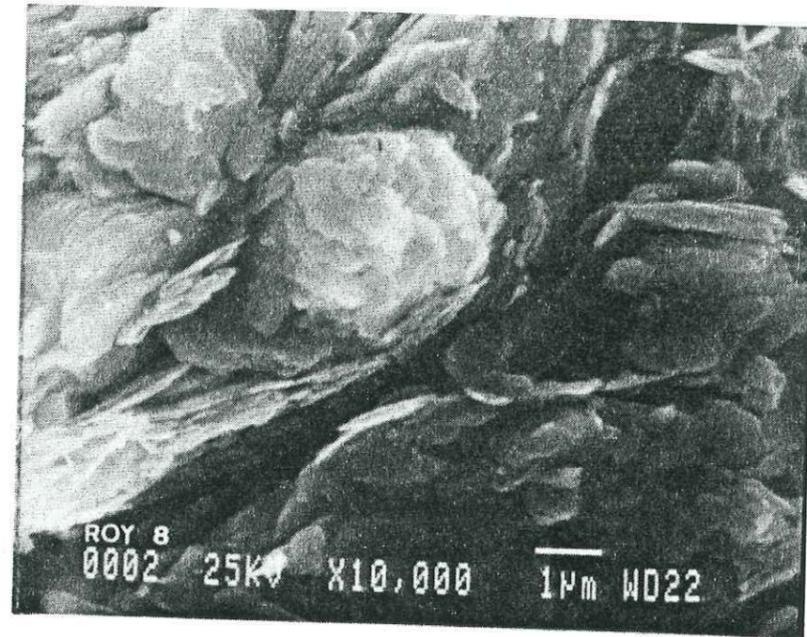
Photo 2. Photo 1 prise par le faisceau électronique rétrodiffusé: la couleur blanche est due aux oxydes de fer.
