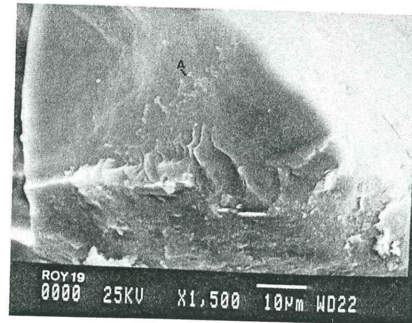
Photo 1. Corrosion partielle en forme d'escalier d'une surface fissurée du quartz.
