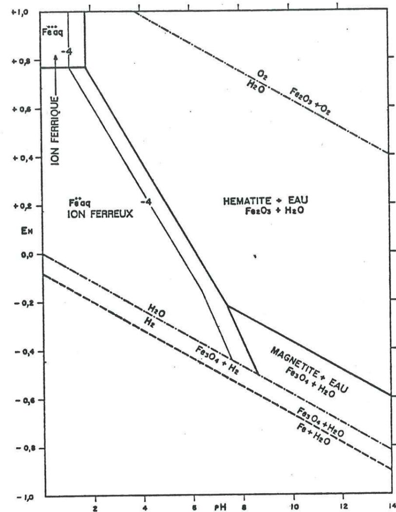
Fig 1.7. Diagramme composite montrant les domaines de stabilité de l'hématite et de la magnétite dans l'eau à 25°C et 1 atmosphère. Le domaine des ions est délimité par les contours correspondant à des activités des espèces en solution égales à  $10^{-6}$ . Les contours correspondant à une activité égale à  $10^{-4}$  sont signalés pour indiquer la pente de la variation d'activité (GARRELS, CHRIST, 1967).
