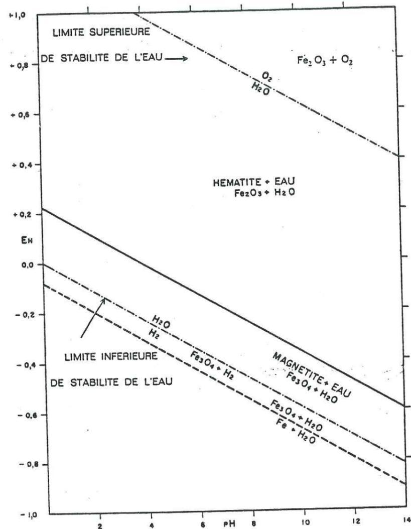
Fig. 1.6. Domaine de stabilité des oxydes de fer en fonction du Eh et pH à 25°C et à une pression totale de 1 atmosphère. La droite en traits interrompus correspond à la limite inférieure de stabilité de la magnétite en présence d'eau métastable (GARRELS, CHRIST, 1967).
