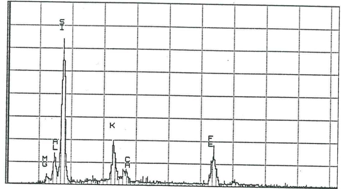
Fig.2. Analyse chimique par microscope électronique à balayage d'une écaille d'altération de glauconie (2).
