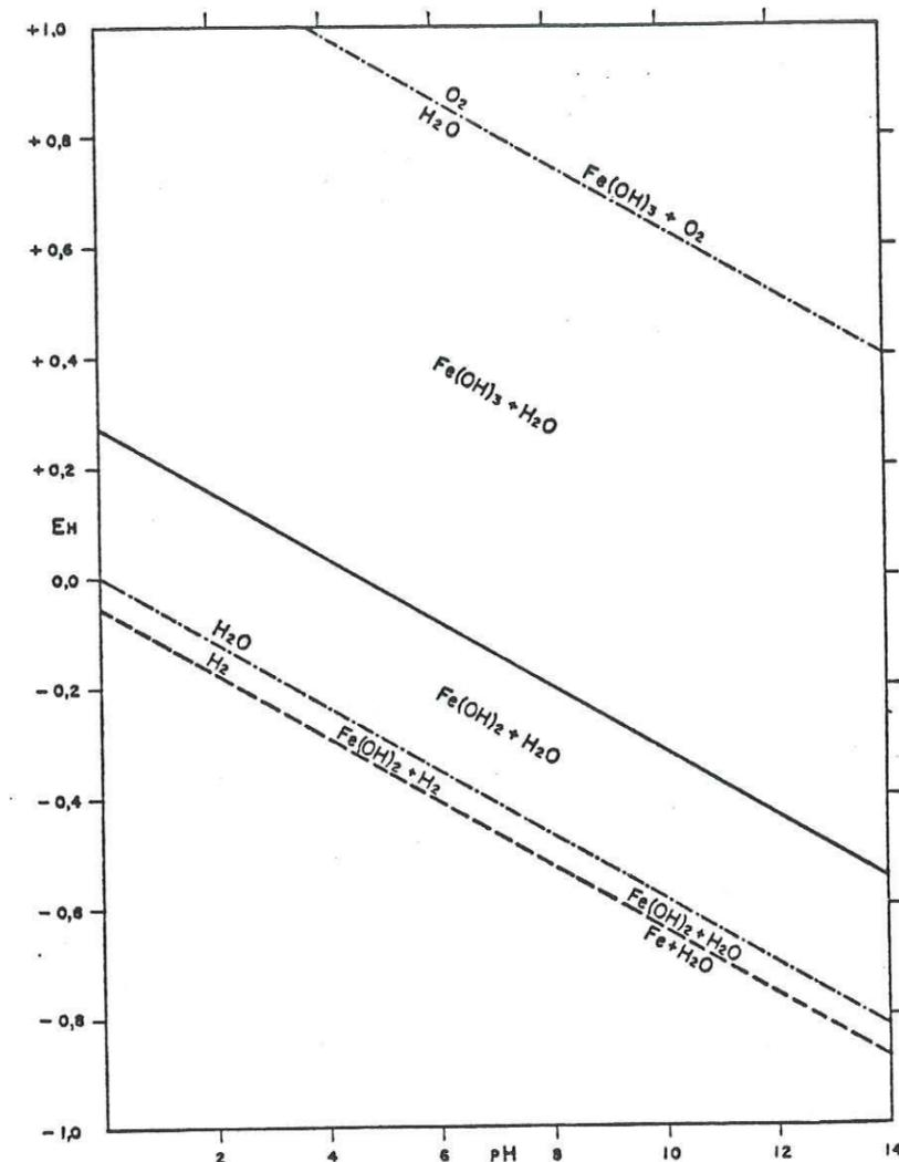
Fig 1.5. Diagramme montrant les domaines de stabilité des hydroxydes ferreux et ferriques à 25°C et à une pression totale de 1 atmosphère. La limite de stabilité de l'eau est aussi indiquée. La droite en traits interrompus correspond à l'équilibre métastable entre Fe et  $\text{Fe}(\text{OH})_2$  dans l'eau. (GARRELS, CHRIST, 1967).
