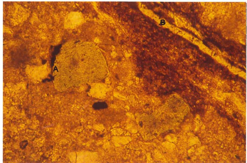
Photo 1. Quartz fissuré montrant des fissures à remplissage argileux.
