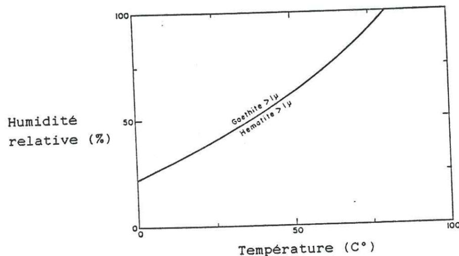
Fig.1.4. Humidité relative pour l'équilibre entre les grains de goethite et d'hématite de 0 à 100°C, à pression 1 bar. Le cristal de goethite, dont la dimension est de 0,1 $\mu$ , est relativement instable par rapport à l'hématite dans ces conditions (LANGMUIR, 1971, Fig.2, p.150).
