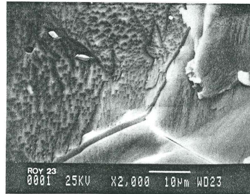
Photo 1. Corrosion sur la surface conchoïdale du quartz.
