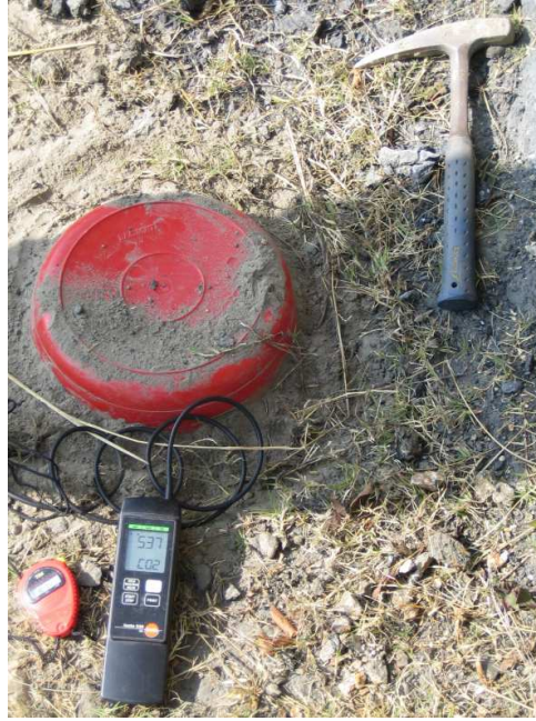
FIGURE 6.4 – Chambre d'accumulation et capteur de concentration de CO 2 TESTO 535.
