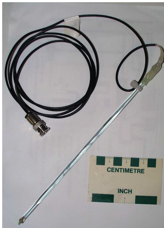
FIGURE 5.5 – Une électrode impolarisable Cu/CuSO_4 de type "Maineult".
