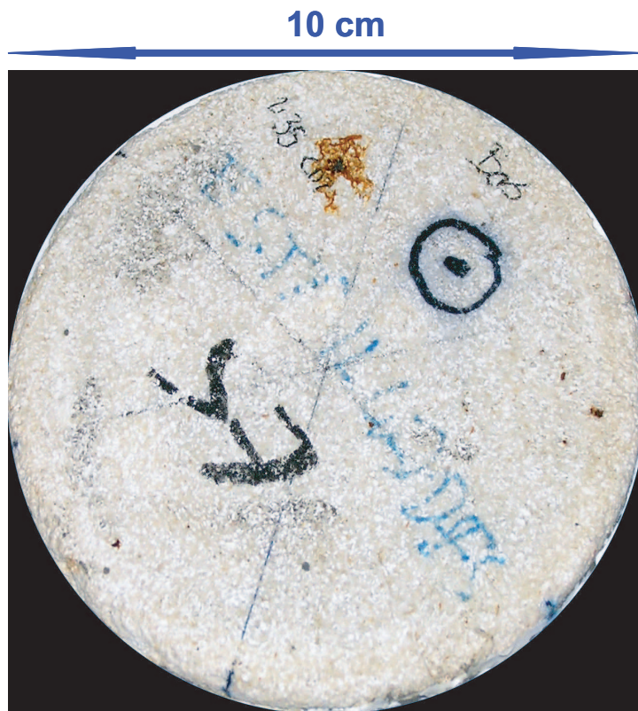
FIGURE 4.20 – Face de sortie de l'échantillon de calcaire des Estailades après un mois d'injection d'eau saturée en CO_2 à un débit de 5\text{ml}\cdot\text{min}^{-1} .
