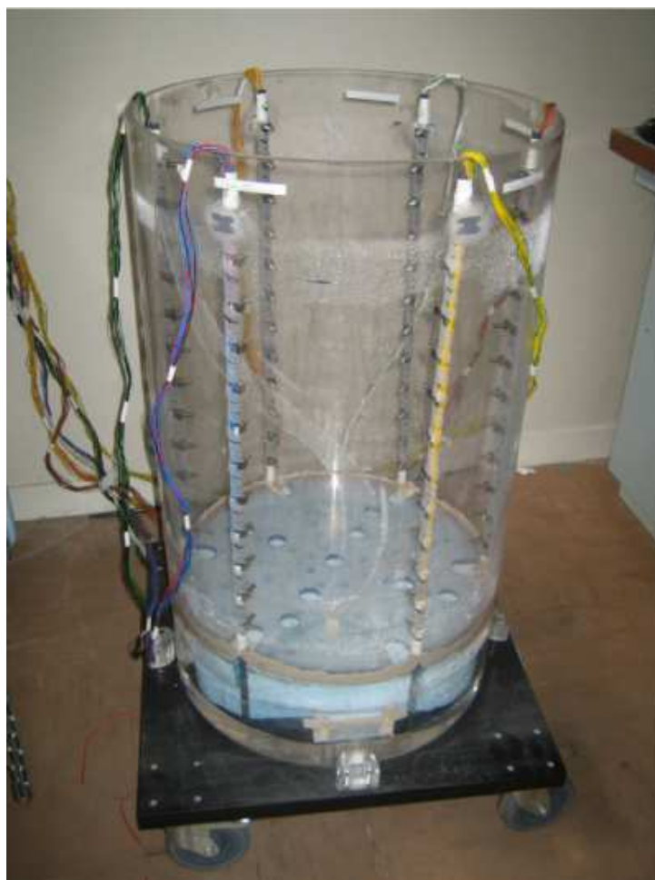
FIGURE 5.7 – Vue de la cuve avec les six tiges supportant les électrodes de résistivité électrique.
