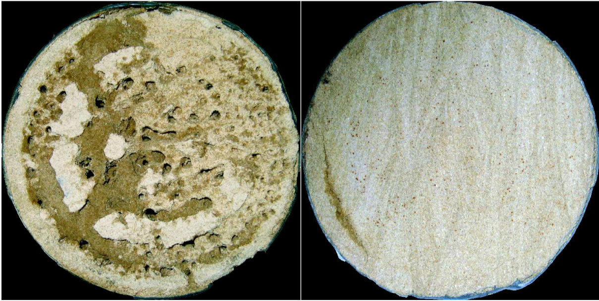
FIGURE 4.24 – Face d'entrée (à gauche) et de sortie (à droite) de l'échantillon de calcaire de Saint-Maximin après une semaine d'injection d'eau saturée en CO_2 à un débit de 10\text{ml}\cdot\text{min}^{-1} .
