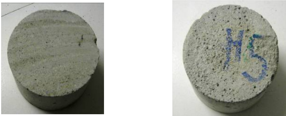
Figure II-20. Photos d'une éprouvette vierge (avant essai) et endommagée (après essai)
