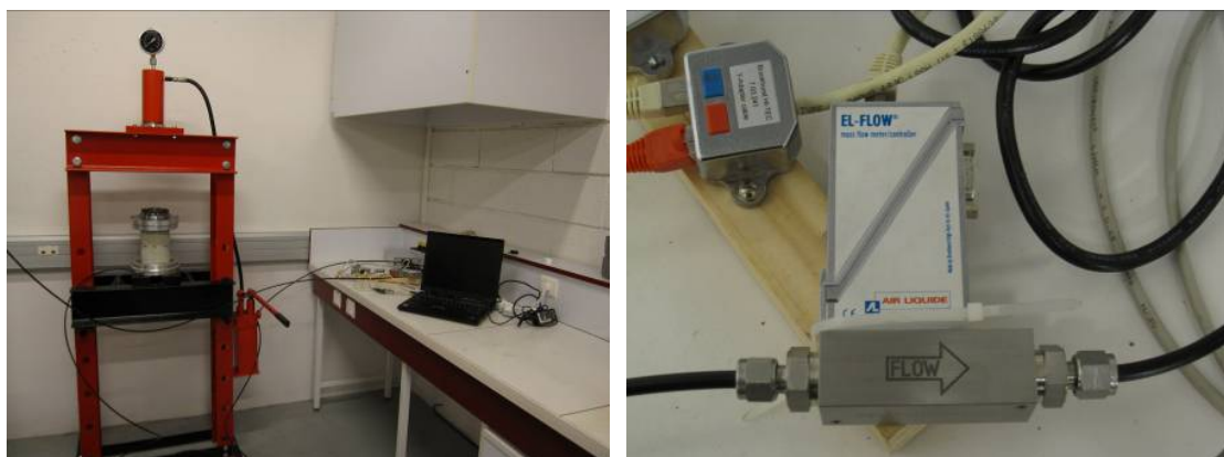
Figure III-14. Dispositifs de mesure de la perméabilité radiale
