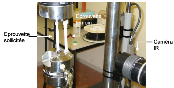
(a) (b) Figure 2.3. : Maîtrise des conditions expérimentales, d'après [Cn6] (a) dérive de la température ambiante (b) mise en place d'une éprouvette de référence
