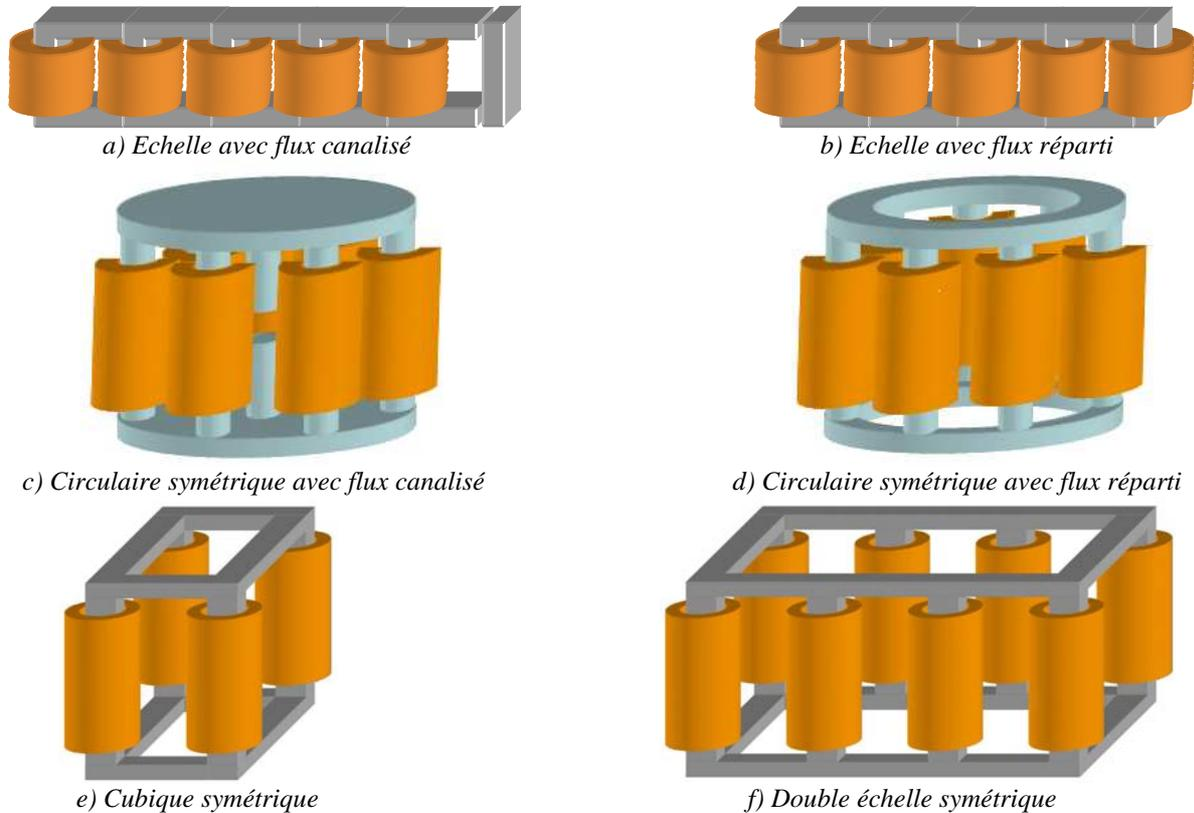
Figure 2 : Transformateurs Inter-cellules.
