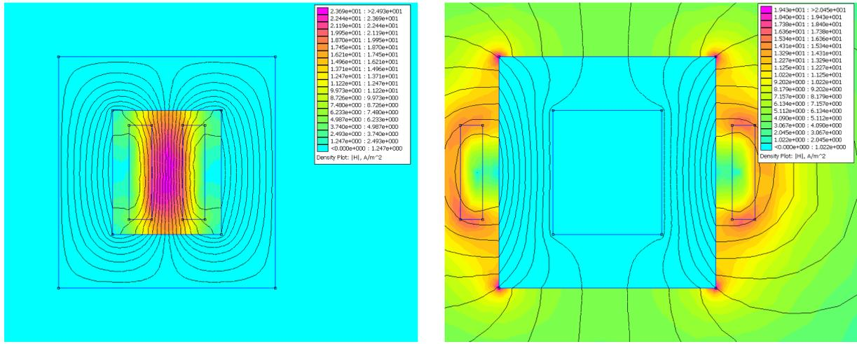
a) Conducteurs à l'intérieur de la fenêtre de bobinage b) Conducteurs à l'extérieur de la fenêtre de bobinage
