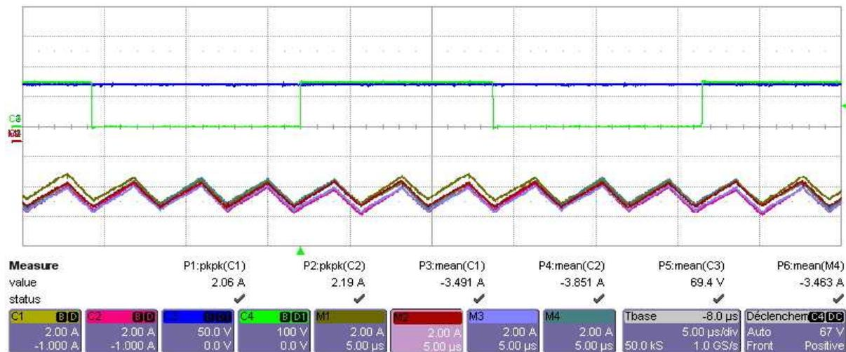
Figure 9 : Les courants dans les six cellules de commutations.
