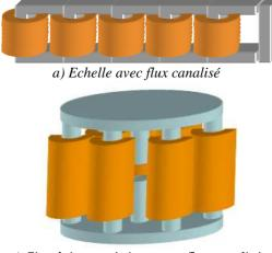
c) Circulaire symétrique avec flux canalisé
