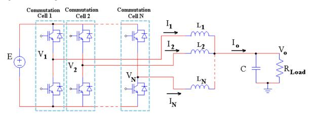
Figure 1 : Hacheur abaisseur parallèle multicellules.
