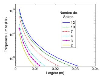
Figure 6 : Variation de la fréquence limite.
