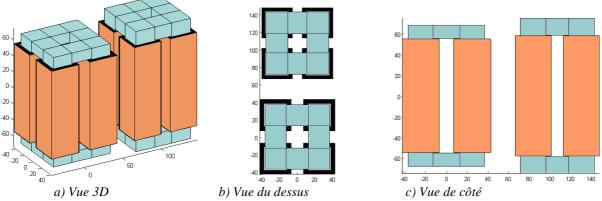
Figure 12 : Forme final des ICTs optimisés en utilisant des matériaux conducteurs différents (échelle en millimètre).
