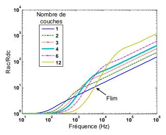
Figure 5 : Variation de la résistance AC avec la fréquence pour chaque configuration de la Figure 4.
