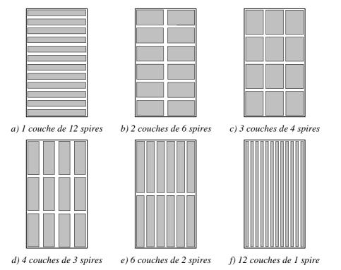
Figure 4 : Configurations pour mettre 12 conducteurs dans la fenêtre de bobinage.
