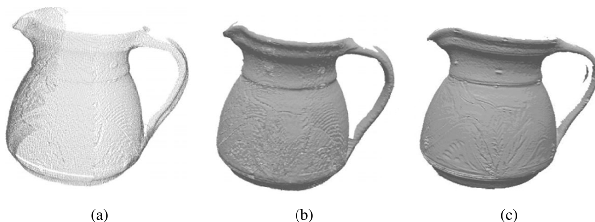
FIGURE I.12 – Résultat du scanning à l’aide du scanner 3D multispectral : (a) nuage de point, (b) surface triangulée, (c) résultat du scanner professionnel Minolta VIVID-910.
