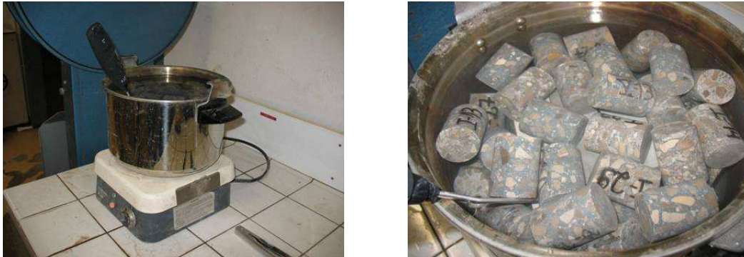
Fig. 2. 7 : Changement de température sous eau des éprouvettes de 50°C et 80°C avant mise en place en conditionnement
