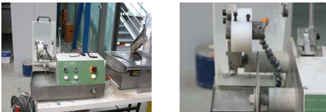
**Fig. 2. 5 : Machine à tronçonner et tronçonnage des éprouvettes cylindriques**
