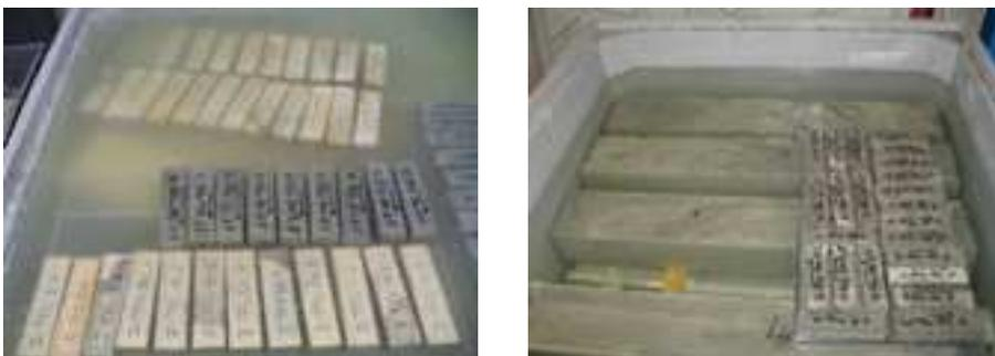
Fig. 2. 3 : Poutres et prismes placés dans le bain thermostaté à  $20^\circ\text{C}$
