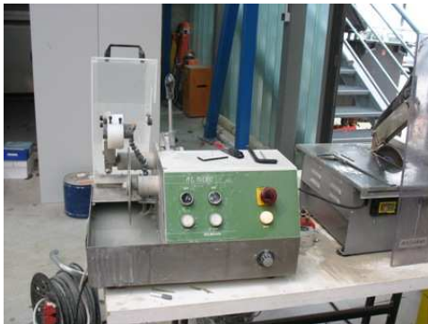
Fig. 2. 5 : Machine à tronçonner et tronçonnage des éprouvettes cylindriques
