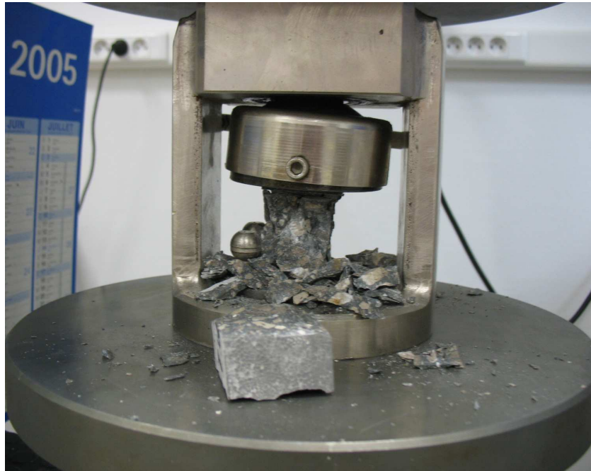
Fig. 3. 71 : Rupture d'un prisme de CEM V après l'essai de compression uniaxiale
