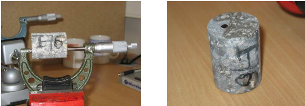
Fig. 2. 9 : Principe de la mesure de retrait/gonflement sur éprouvette cylindrique
