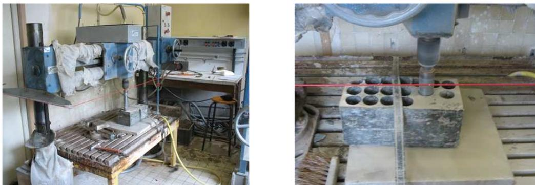
**Fig. 2. 4 : Machine à carotter et carottage des poutres de béton**
