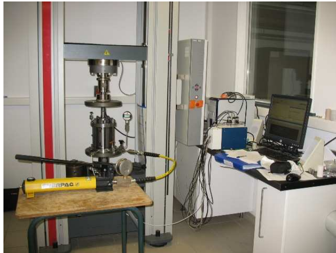
Fig. 2. 24 : Cellule auto compensée installée sur la presse
