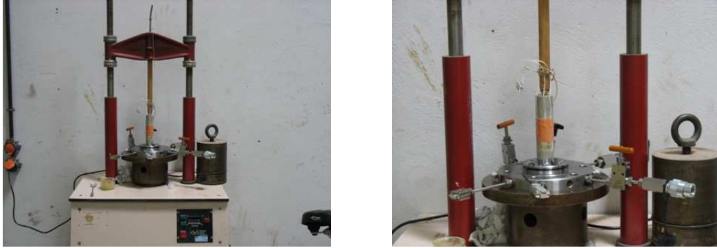
Fig. 2. 23 : Préparation de l'échantillon la veille de l'essai de compression triaxiale
