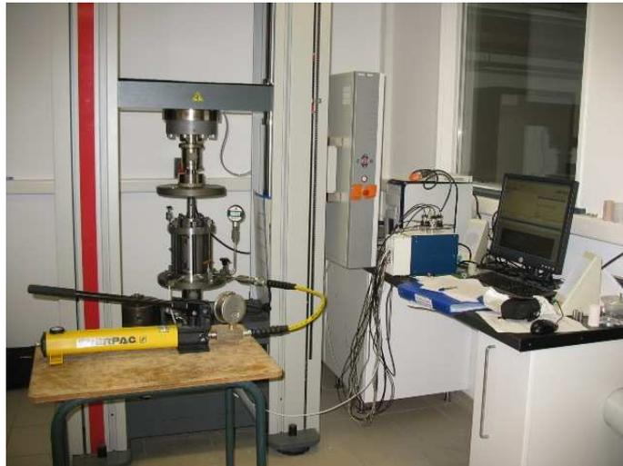
**Fig. 2. 24 : Cellule auto compensée installée sur la presse**
