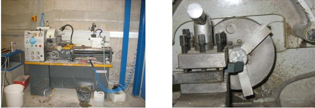
**Fig. 2. 6 : Tour d'usinage et rectification des éprouvettes cylindriques**
