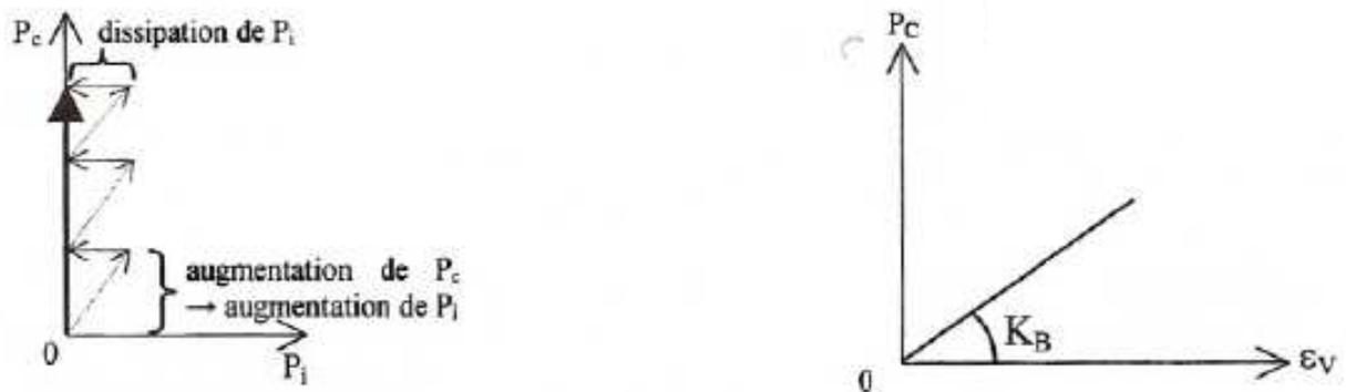
Fig. 2. 13 : Schématisation de la mesure de  $K_b$  [Lion 04]
