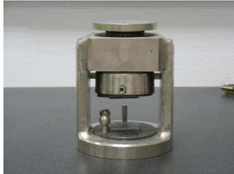
Fig. 2. 20 : Bâti de compression pour la compression sur demi-prismes
