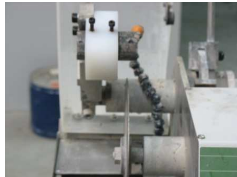
Fig. 2. 5 : Machine à tronçonner et tronçonnage des éprouvettes cylindriques
