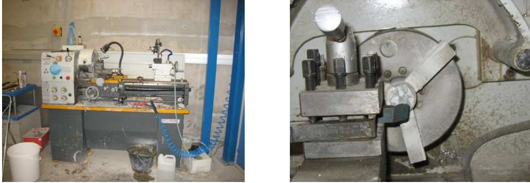
Fig. 2. 6 : Tour d'usinage et rectification des éprouvettes cylindriques
