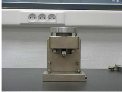
Fig. 2. 26 : Bâti de flexion pour l'essai de traction par flexion
