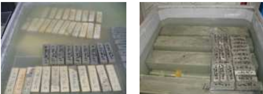
Fig. 2. 3 : Poutres et prismes placés dans le bain thermostaté à 20^\circ\text{C}
