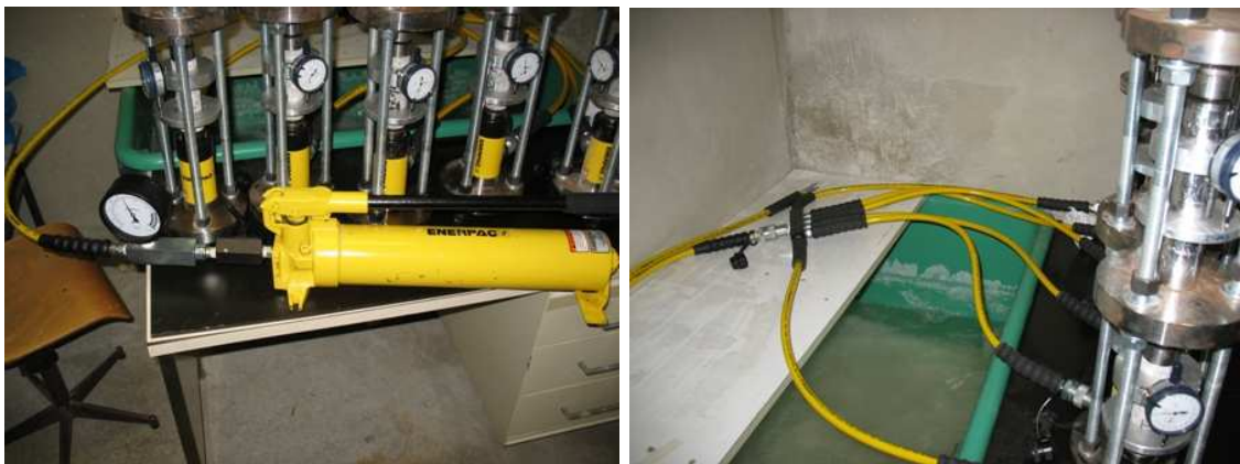
Fig. 2. 29 : Pompe et sa nourrice pour maintenir la contrainte de fluage
