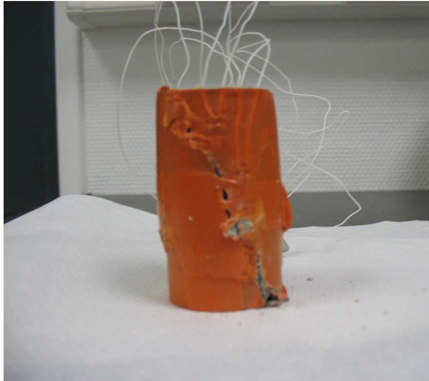
Fig. 3. 73 : Eprouvette de CEM V (état sec) après l'essai de compression triaxiale
