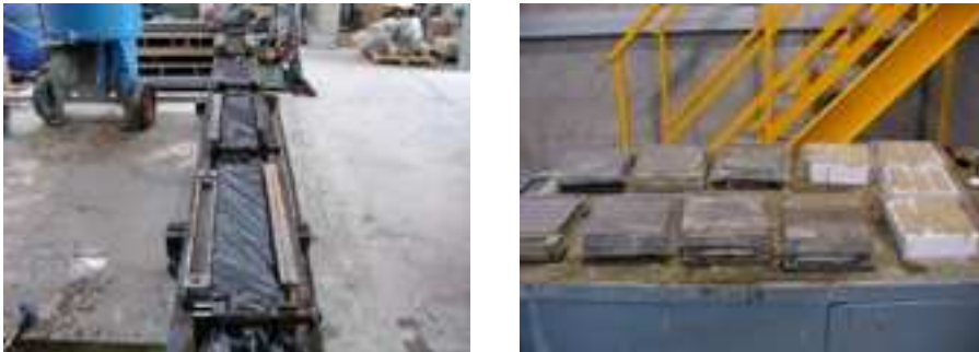
Fig. 2. 2 : Coffrage et moules protégés du séchage après le coulage
