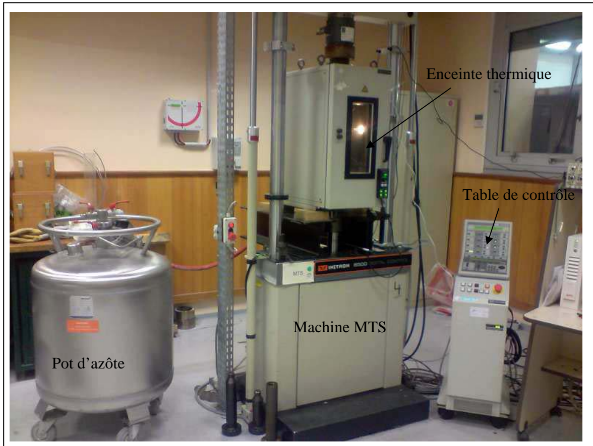
Figure A-3 : Dispositif d'essais de traction simple du métal déposé.
