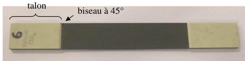
Figure 2.3 Géométrie des éprouvettes
