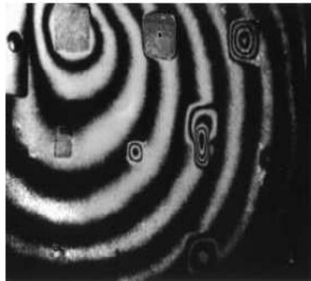
*Figure 4. 2 Détection d'implants de téflon simulant des délaminages dans un matériau composite, par interférométrie holographique [Lam98]*
