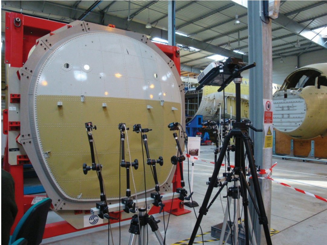
Figure 5. 27- Configuration des caméras pour la mesure du 'bouclier'
