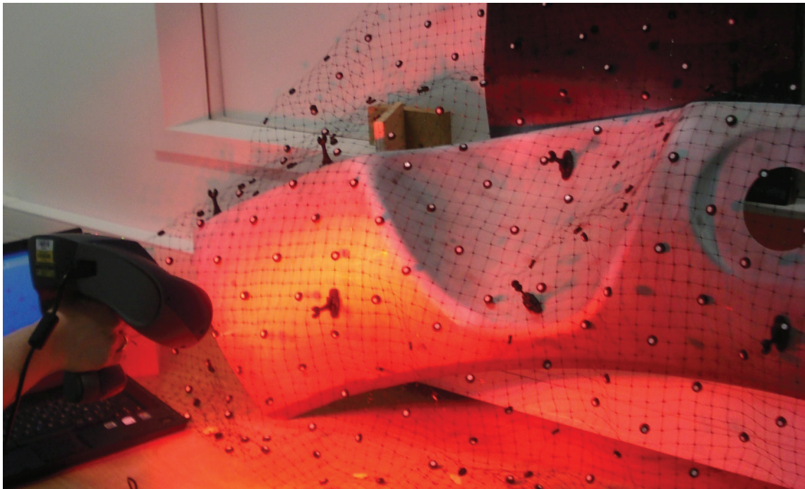
Figure 5. 5- Marqueurs fixes disposés autour de la pièce (Filet HandyScan®)
