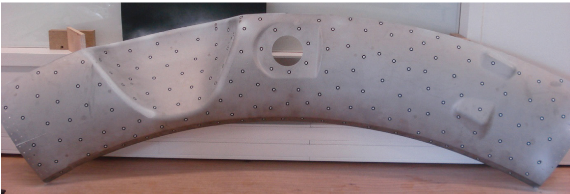
Figure 5. 7- Pastilles autocollantes utilisées pour le recalage par le système HandyScan®
