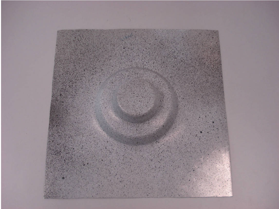
Figure 2. 11 - Pièce réalisée par formage incrémental à l'ENSM de Besançon
