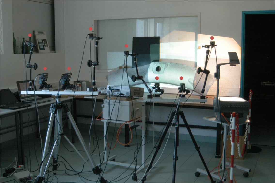
Figure 1. 2- Configuration murale du système multi-caméras pour mesurer la 'banane'
