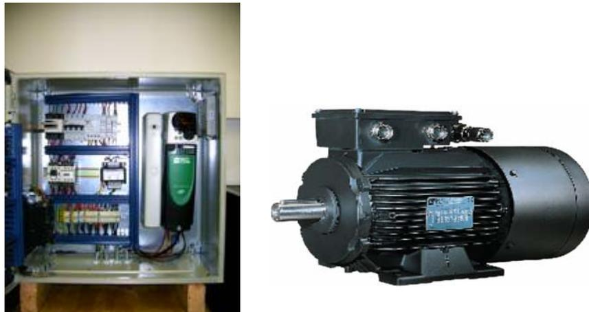
Fig 2.1 : Ensemble variateur de vitesse-machine asynchrone.
