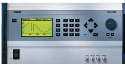
Fig 2.2 : La source de tension triphasée.
