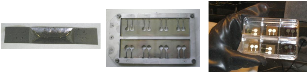
Photo 2 : Creuset pour le dépôt de l'aluminium (À gauche) ; Masque (Au centre) permettant d'évaporer l'aluminium sur les cellules (À droite).
